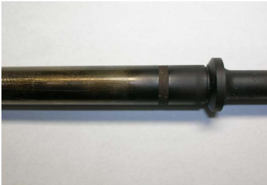
図 3-24. 制御弁ステム部カーボンスラッジ付着及び当たり状況
