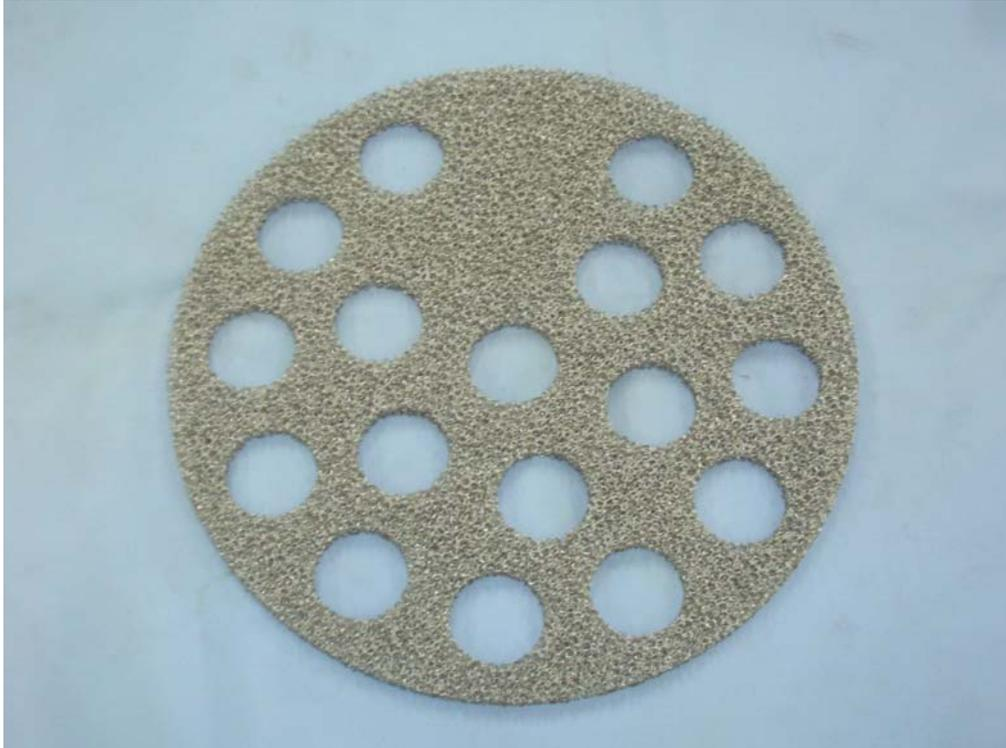
図 4-14. 排ガス通路側の多孔質体
