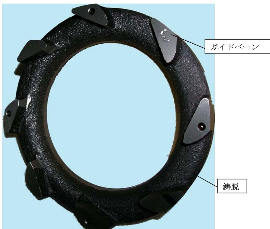
図 4-19. タービンノズルの完成図
