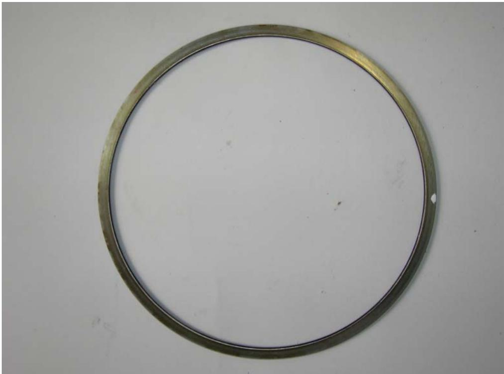
図 3-23. ポアガスケットのシール状況
