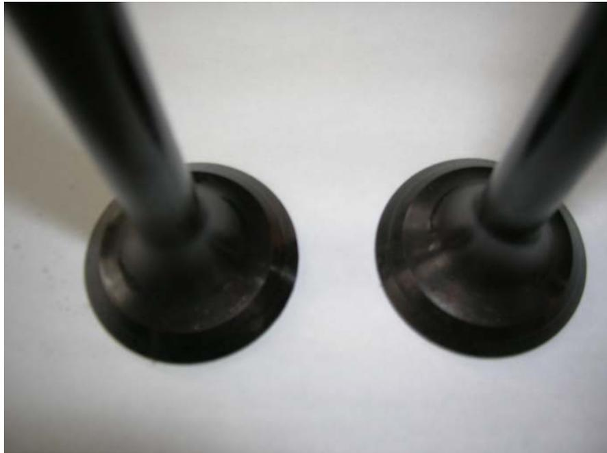
図 3-27. 排気バルブシート部カーボンスラッジ堆積状況
