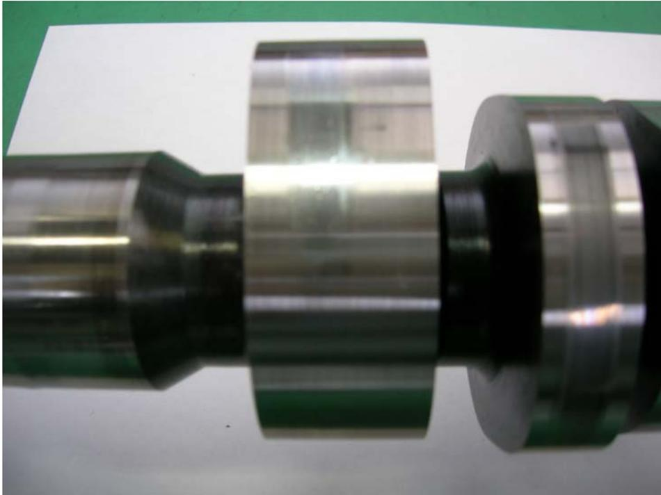
図 3-30. 吸気カム（上図）、排気カム摺動当たりの状況
