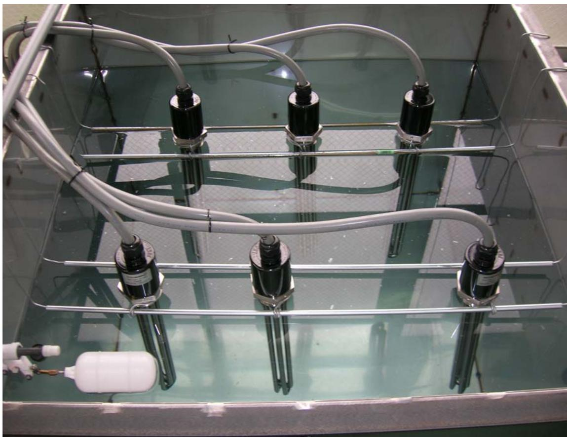
図 4-26. 発電電力の熱吸収水槽
