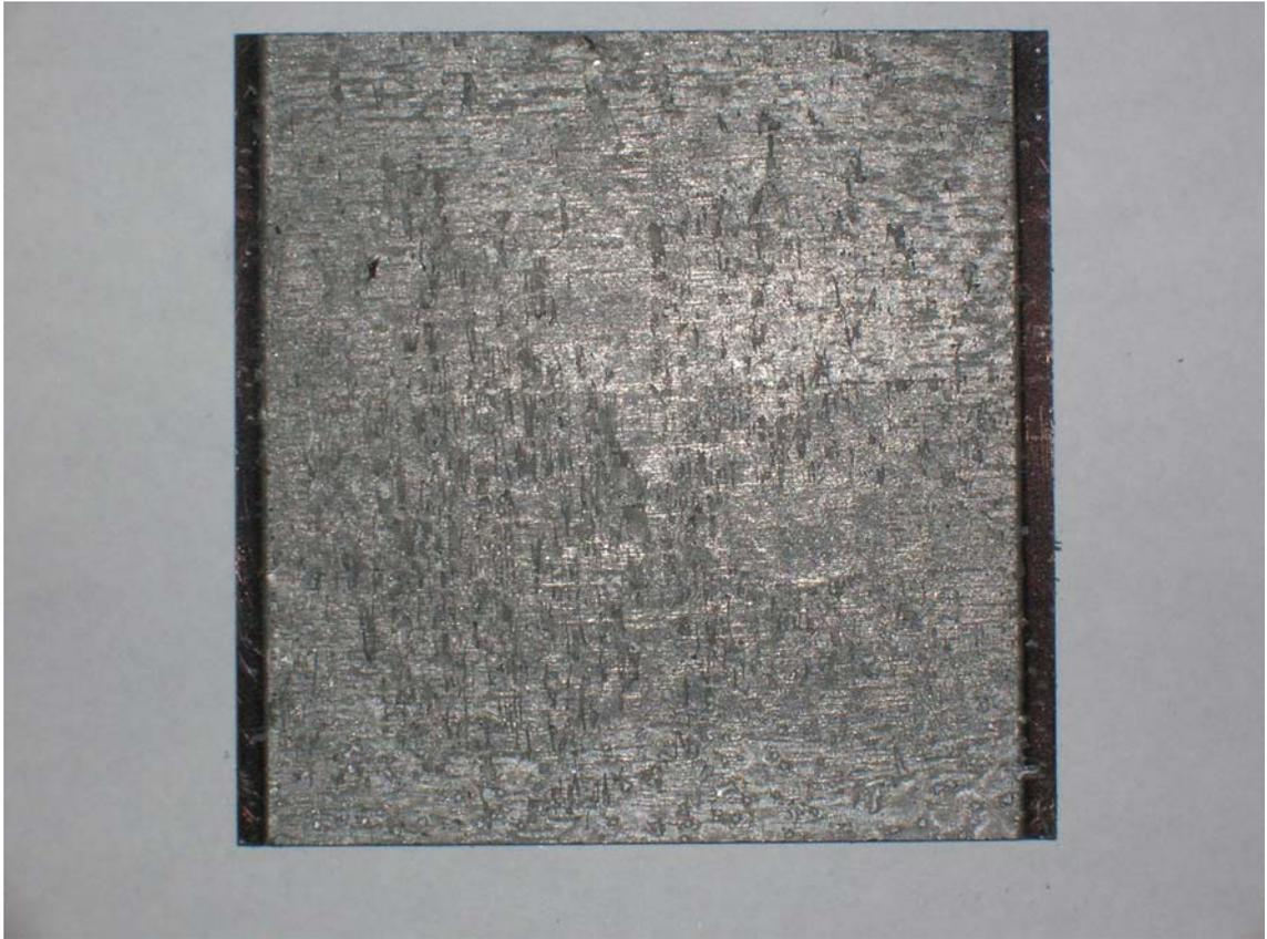
図 5-30. 剥離した接合体の隔壁部
