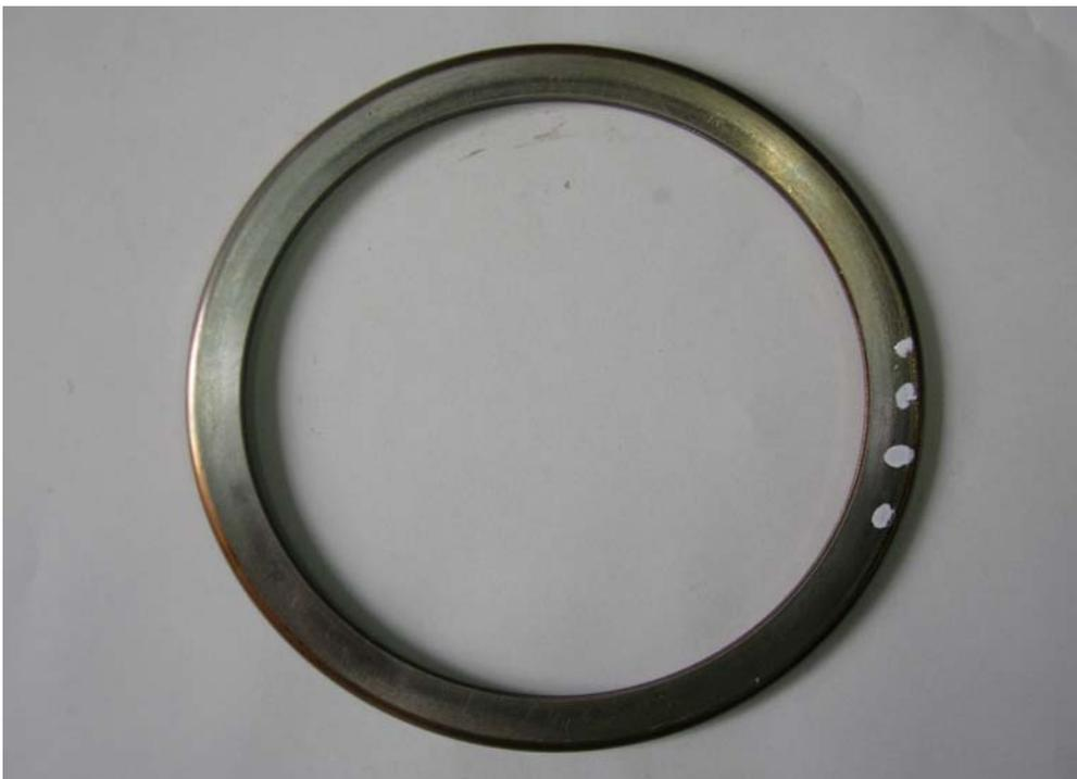
図 3-21. ピストン積層ガスケットのシール状況
