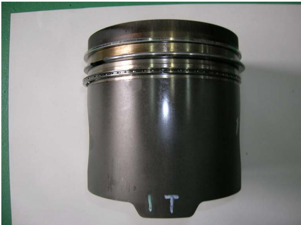
図 3-19. ピストン側面
