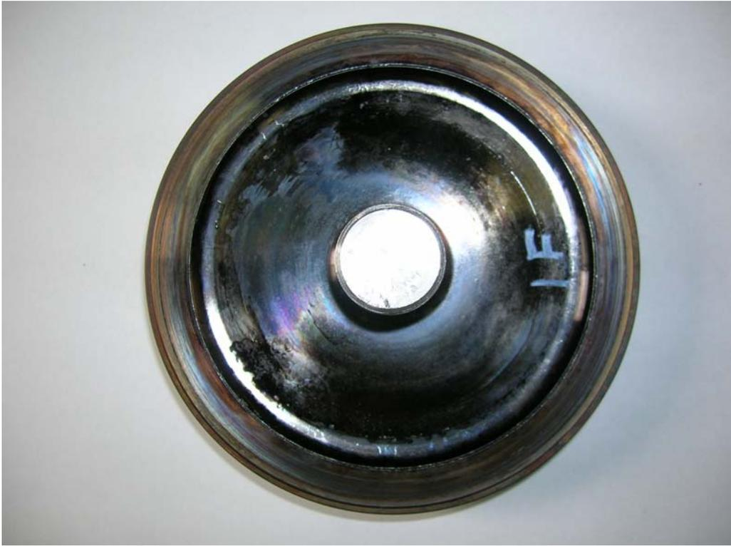
図 3-22. ピストンクラウン下面変色状況
