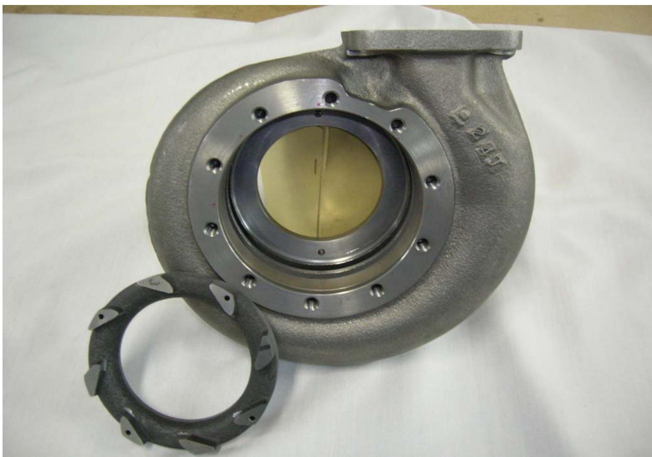
図 4-20. タービンスクロールとノズル
