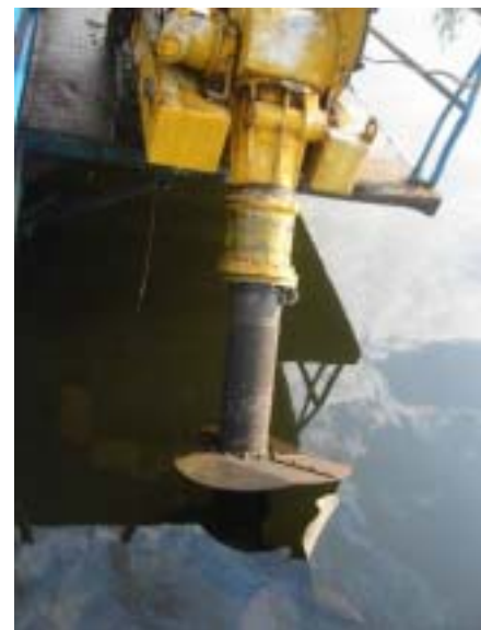
プロペラ損傷状態
