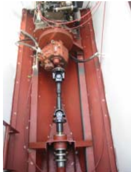
運輸省向けフェリー （自動車エンジンを流用した推進装置）
