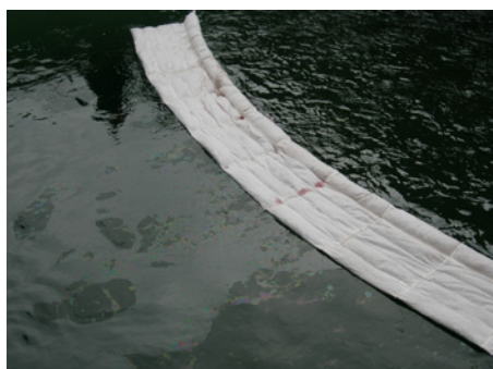
写真-VI. 3. 3 上流から着色した灯油を 投入した様子
