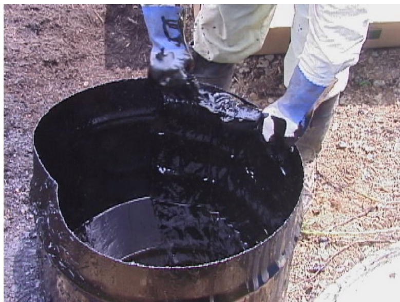
写真－Ⅱ． 2． 1 C重油を吸着マットに吸わせる様子
