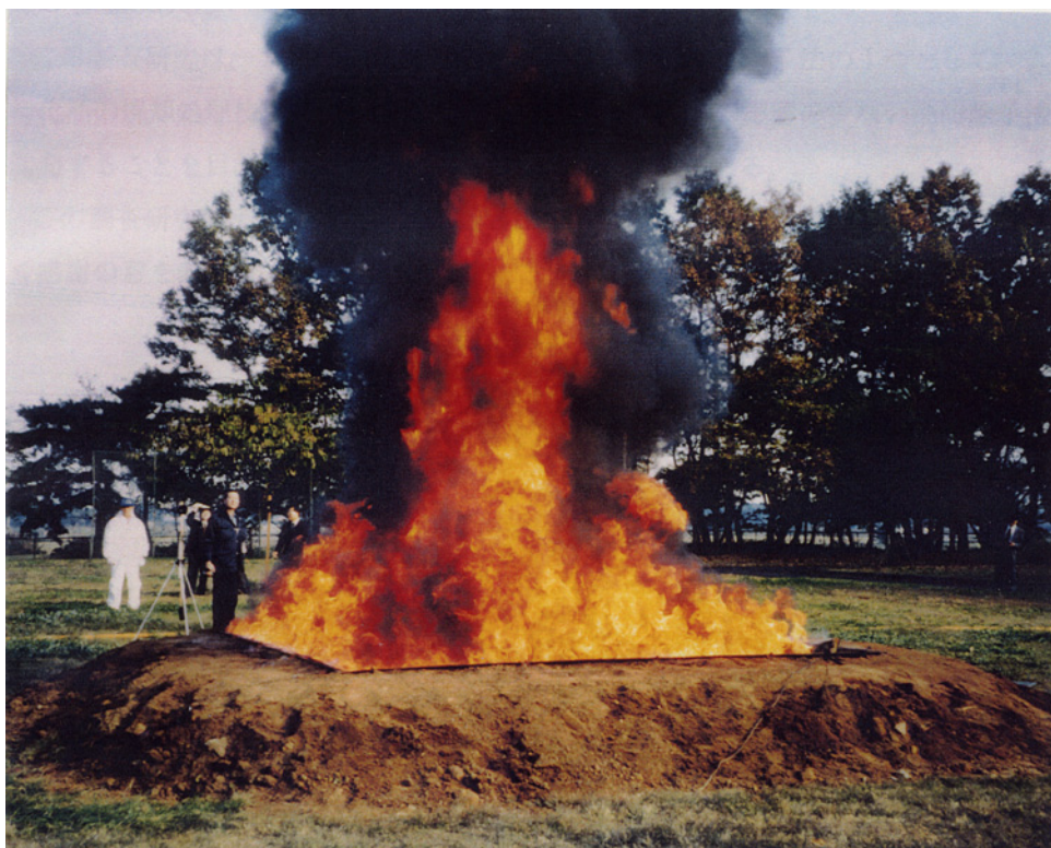
3.5m 角仮設水槽での焼却試験（中規模試験）
