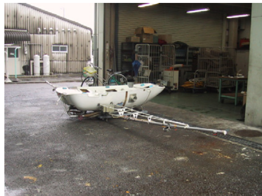
写真4 油分散剤散布装置 (Simplex Model 5100)
