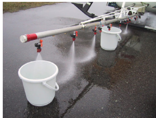
写真6 ノズルの噴射状況
