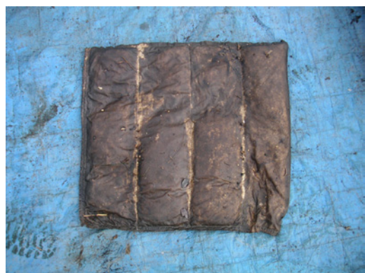
写真－VI. 1. 6 回収された杉樹皮製油吸着材（マット型）
