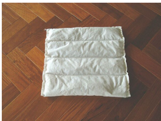
写真－I. 1. 1 杉樹皮製油吸着材「杉の油取り」 マット型（左）と万国旗型（右）
