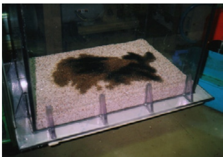
写真 13c 油処理剤を散布直後の状況
