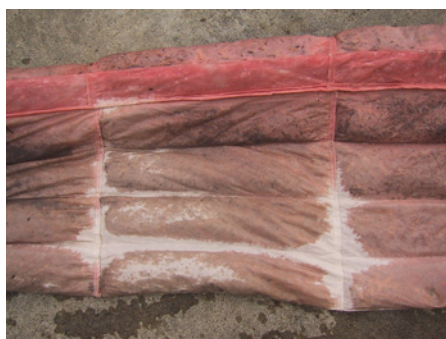
写真-VI. 3. 4 油を吸着したサンプル（河川用の杉樹皮製油吸着材）
