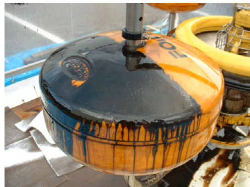
写真 29 灯油洗浄後の状況
