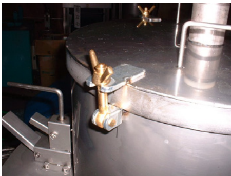
写真5 蓋固定金具の状況
