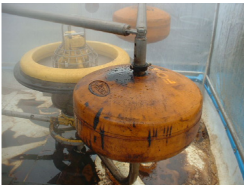
写真 30 灯油洗浄後高圧温水洗浄実施
