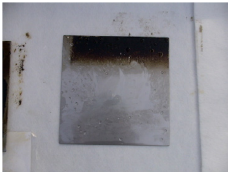
写真 36 灯油洗浄後高圧温水洗浄
