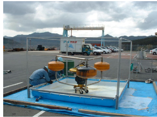
写真11 受皿シートとフレームを S型金具で固定
