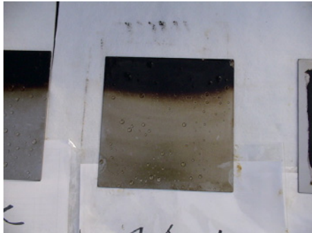
写真 34 スチーム洗浄後の状況
