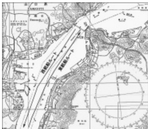
【図2】門司西海岸沖の航路屈曲部でのショートカット航行
