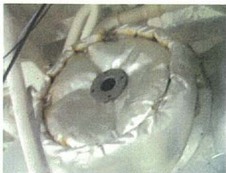
図 2.2.2 NOx センサ取付け用フランジ部
