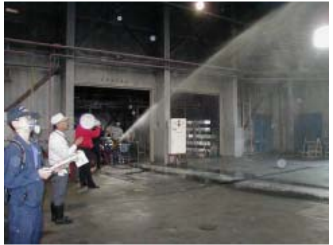
008 ゲル化剤散布の状況（22m）
