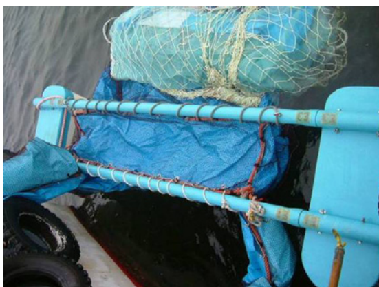
写真IV-3 本体とフロート部の接合状況
