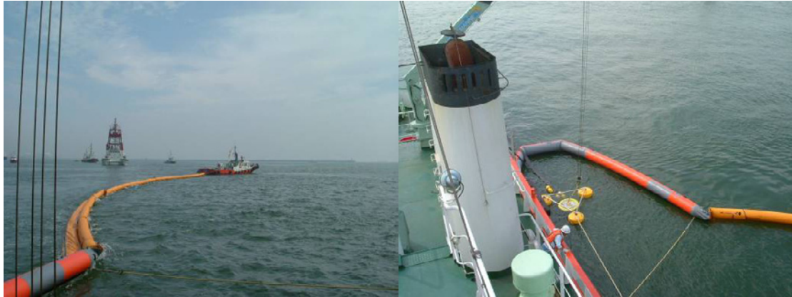
写真IV-14 オイルフェンス展張の状況
