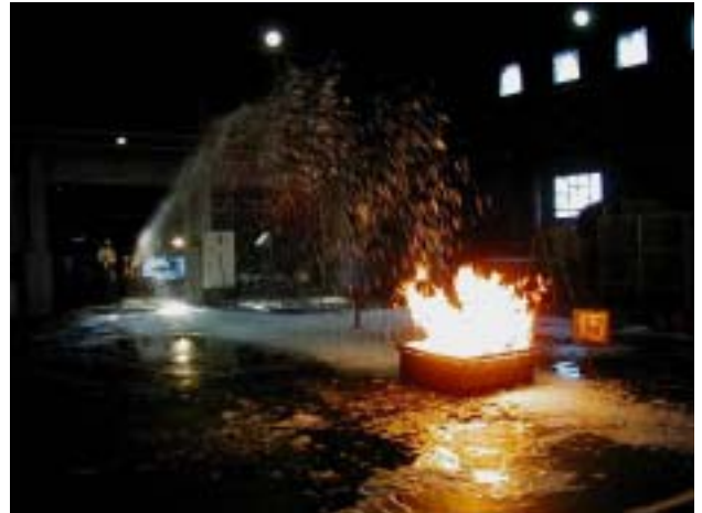
078 アセトン消火ゲル泡 (1.6 m)
