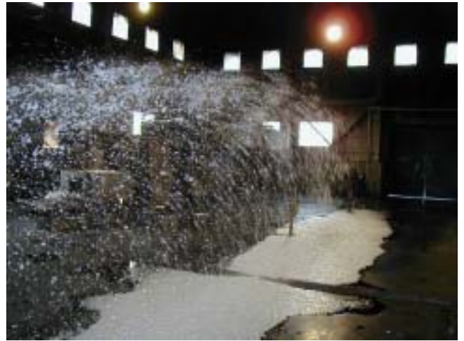
029 3%混合放水の状況（14m）
