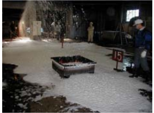
088 アセトン消火ゲル泡 (16m)
