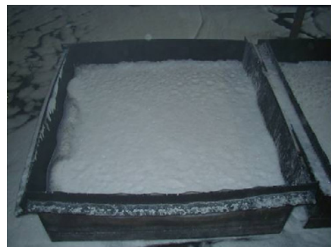
ゲル泡で被覆した状態
