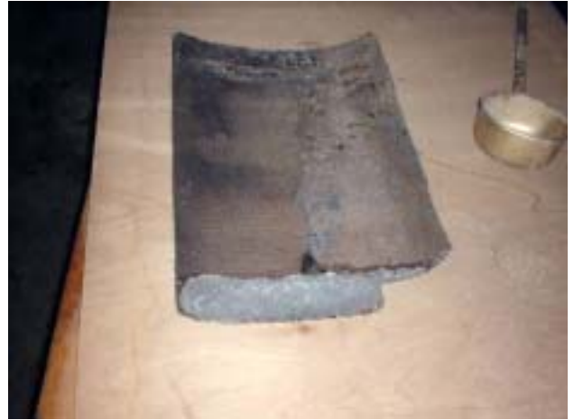
114 網による固化状況の確認
