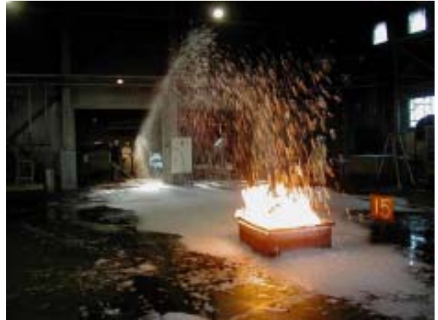
082 アセトン消火ゲル泡 (1.6 m)
