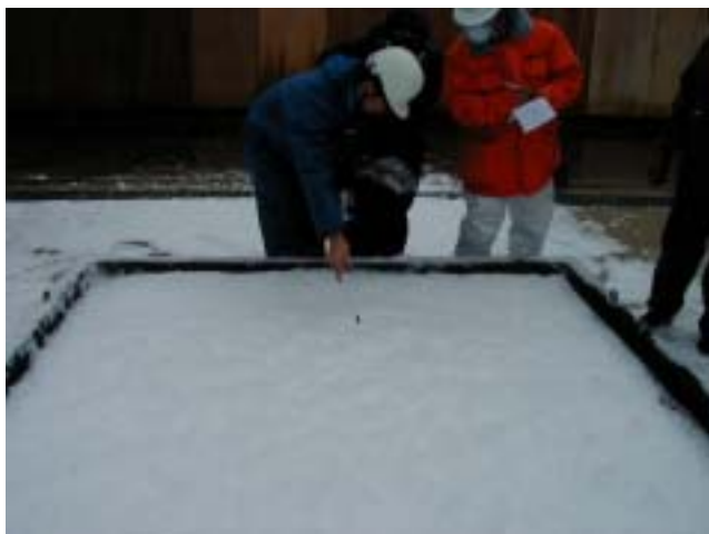
176 ゲル泡散布後ベーパー濃度測定
