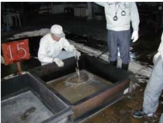
044 火皿への敷水（10 cm）投入作業
