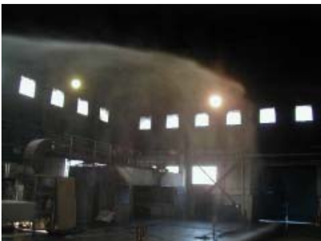
011 ゲル化剤散布の状況（22m）
