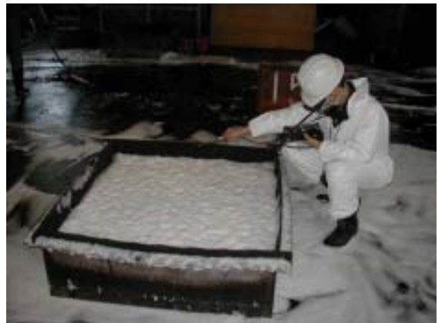
034 ベーパー濃度検知の状況
