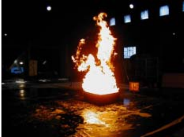
075 アセトン消火ゲル泡 (1.6 m)
