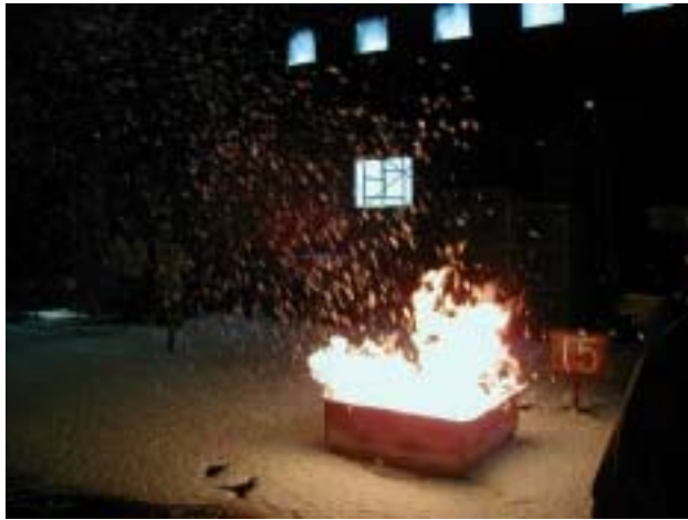
063 アセトン消火 AFFF (1.7m)
