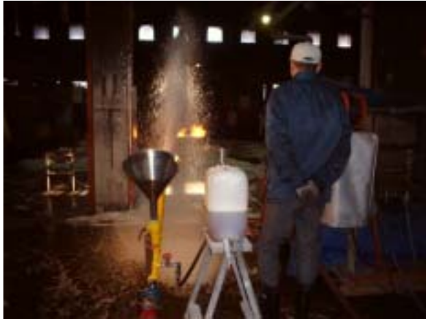
087 アセトン消火ゲル泡 (16m)
