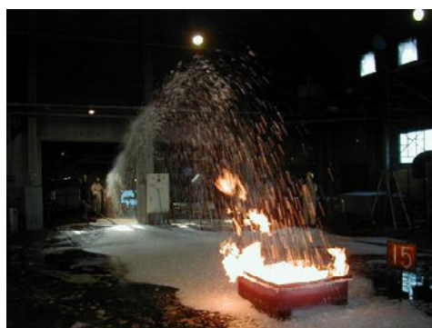
ゲル泡のアセトンへの散布状況
