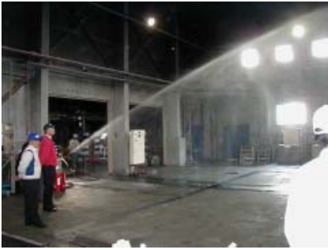
007 ゲル化剤散布の状況（22m）
