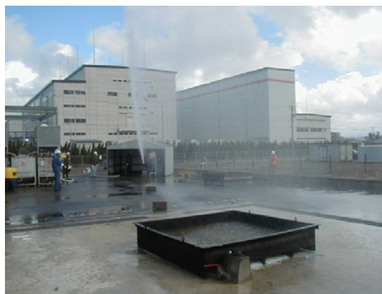
写真Ⅲ－22 仰角 25° での放水状況
