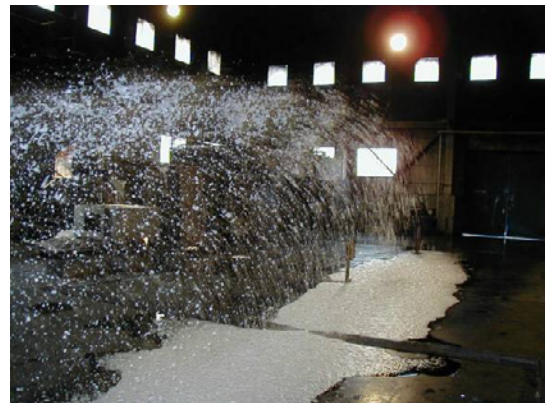
散布距離 1.4 m に低下
