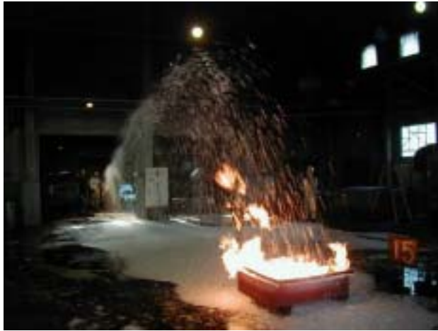
083 アセトン消火ゲル泡 (1.6 m)
