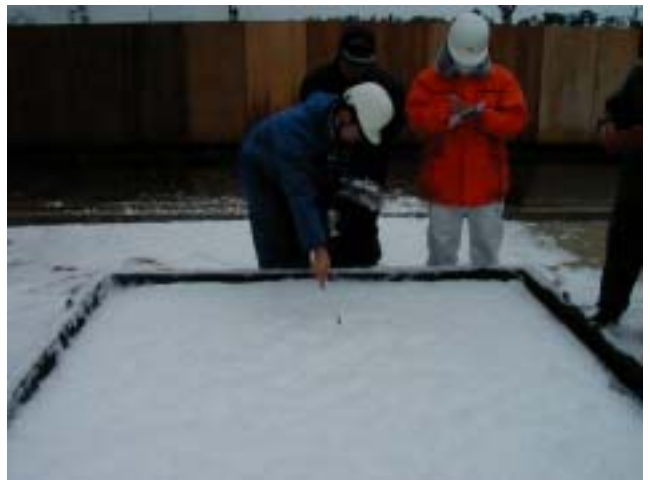
175 ゲル泡散布後ベーパー濃度測定
