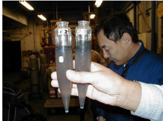
写真Ⅲ－２０ 遠心分離機で分離した状態
