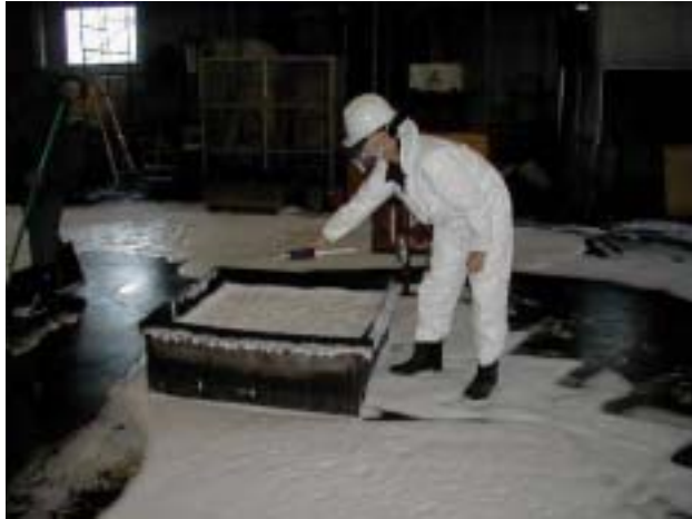
093 ベーパー濃度検知（消火後）
