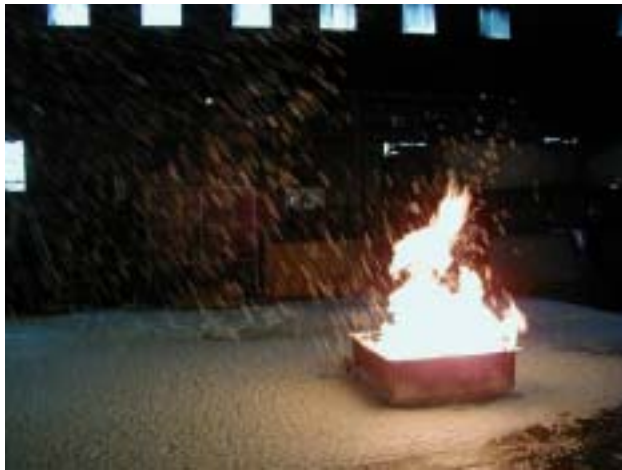
065 アセトン消火 AFFF (1.7m)
