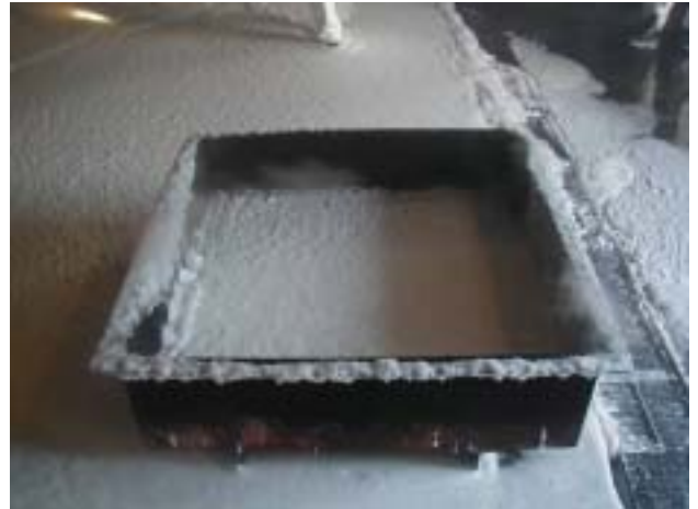
140 ゲル泡1%混合放水被覆状況
