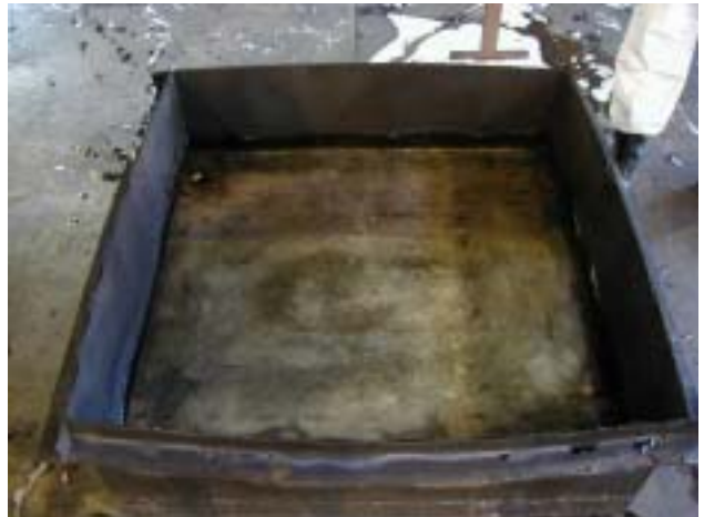
010 キシレン注入後 (10L)
