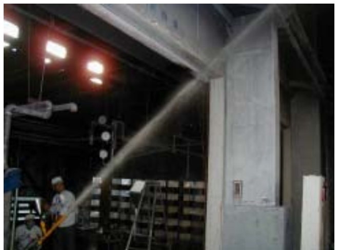
024 仰角 38 度での放水の状況
