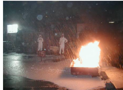
ゲル泡の散布の状況
