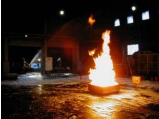
057 アセトン消火 AFFF (1.7m)
