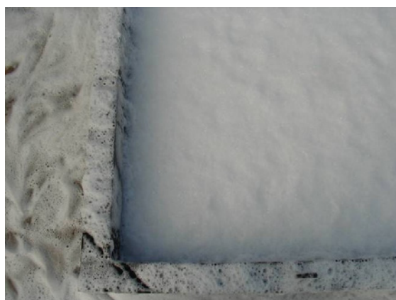
写真Ⅲ-25 ゲル化剤散布後のゲル化状況 写真Ⅲ-26 ゲル泡追加散布後
