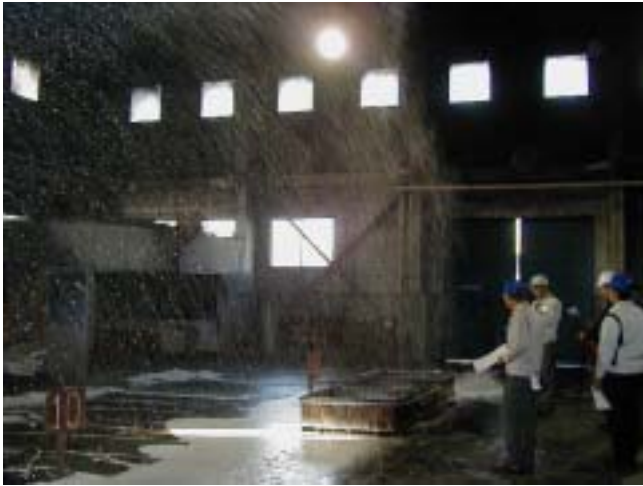
052 ゲル化剤及びゲル泡の散布（1.9m）
