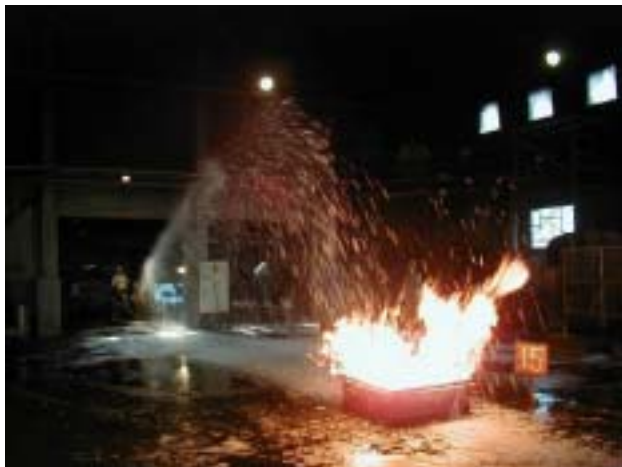
079 アセトン消火ゲル泡 (1.6 m)
