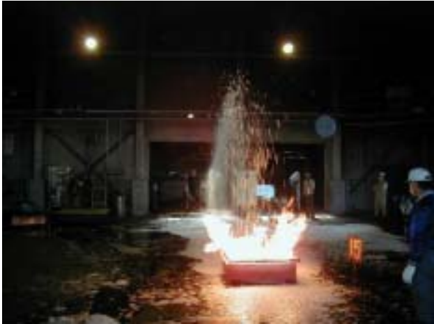
081 アセトン消火ゲル泡 (1.6 m)
