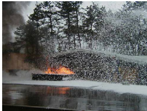
ゲル泡によるキシレンの消火
