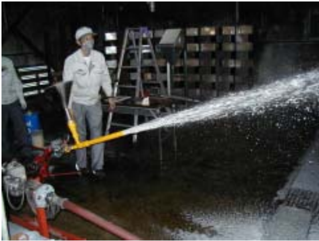
028 3%混合放水の状況（14m）
