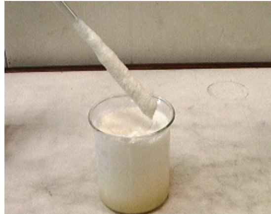
写真Ⅲ-6 ゲル化剤投入後攪拌した状態
