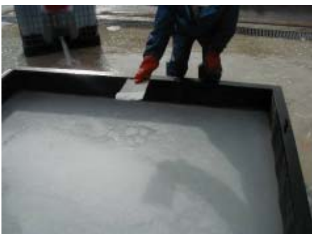
126 ポリマー固化状況
