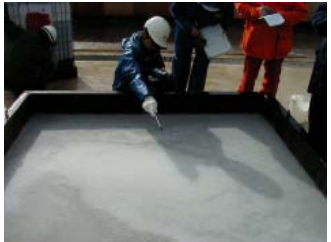
123 追加散布後ベーパー濃度測定
