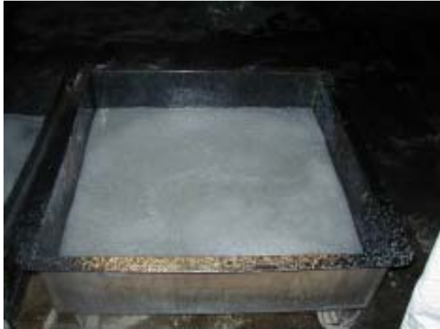
113 ポリマー被膜状況：火皿3（10分後）
