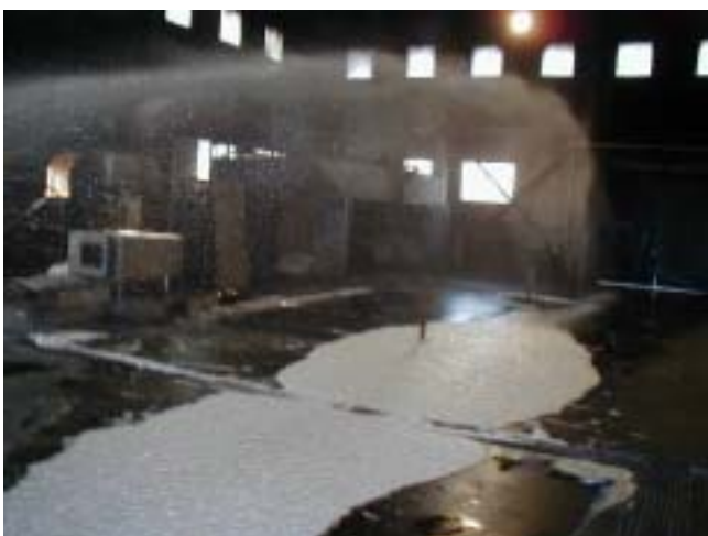
038 ゲル泡（6%型）の1%混合放水 （1.9m）
