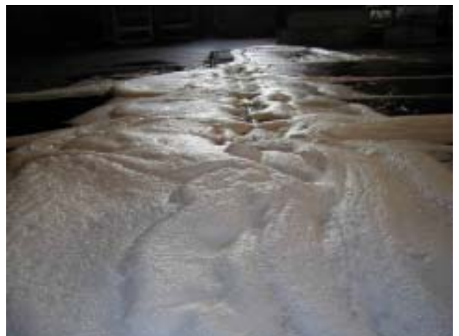
033 ゲル泡（6%型）の3%混合放水後
