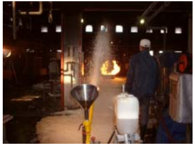
066 アセトン消火 AFFF (1.7m)
