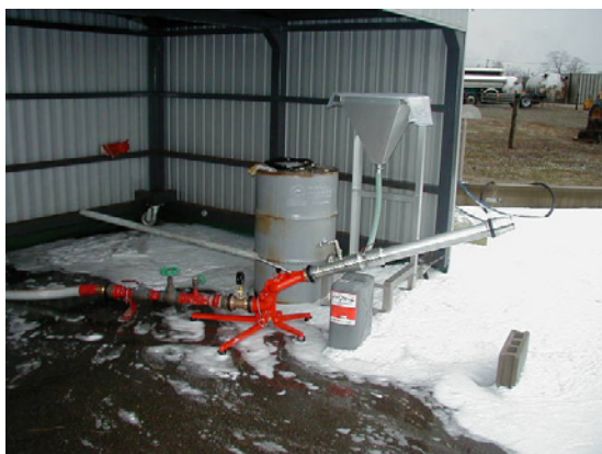
写真Ⅲ－21 屋外散布装置の外観
