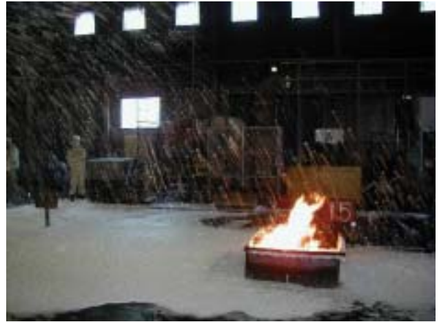
084 アセトン消火ゲル泡 (1.6 m)
