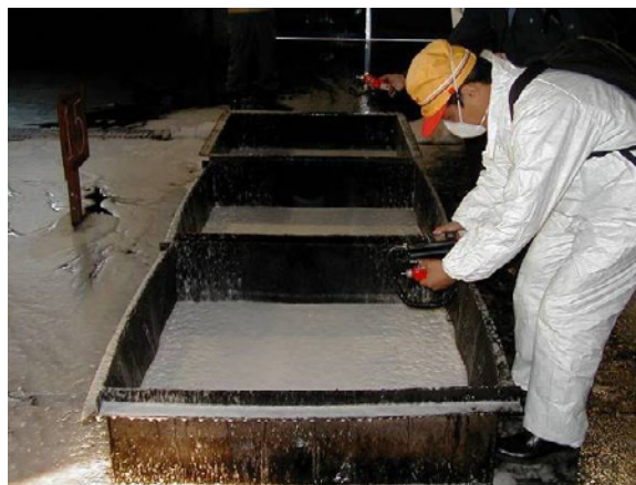
写真Ⅲ－１２ ガス濃度測定状況
