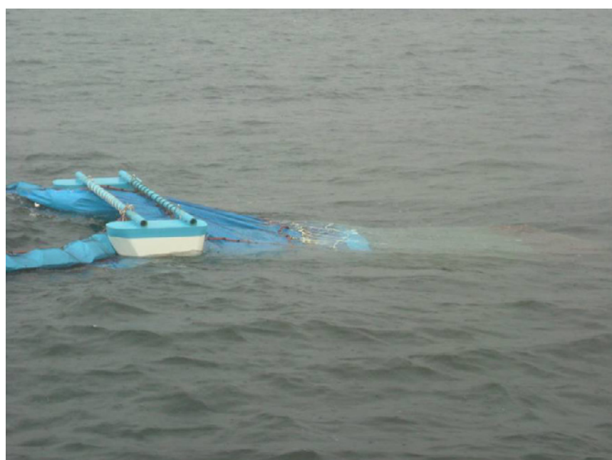
写真IV-6 FRP フロート及び回収バッグの状況
