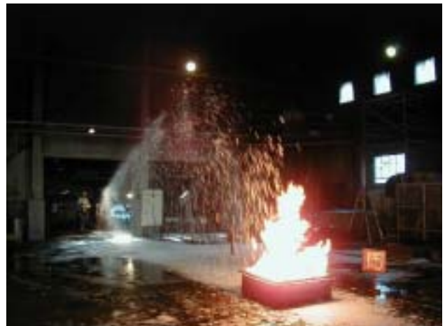
080 アセトン消火ゲル泡 (1.6 m)
