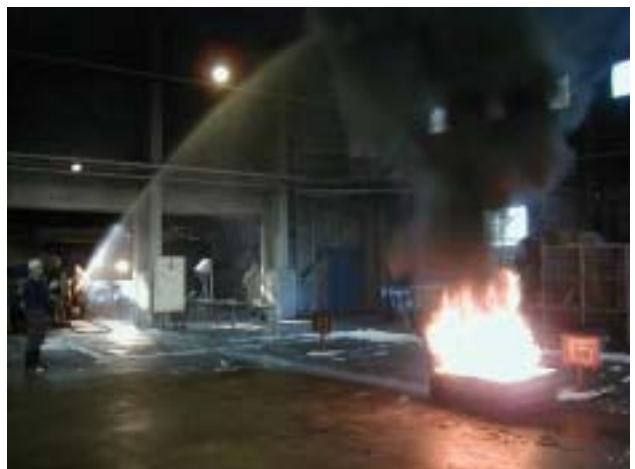
014 キシレン消火 (水のみ) (2 3 m)
