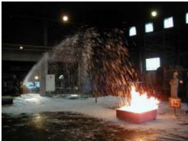
061 アセトン消火 AFFF (1.7m)
