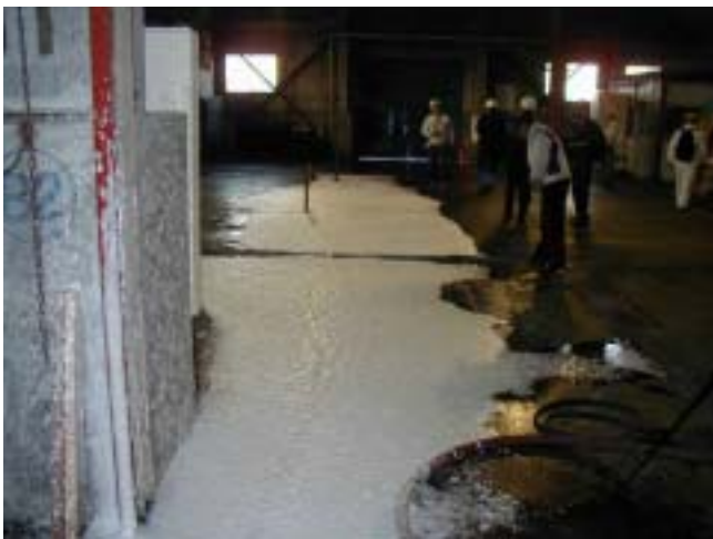
030 3%混合放水後の状況
