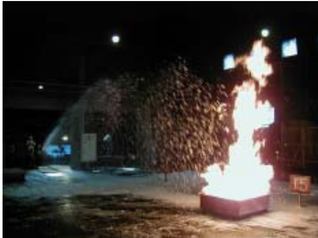
059 アセトン消火 AFFF (1.7m)
