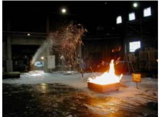
060 アセトン消火 AFFF (1.7m)
