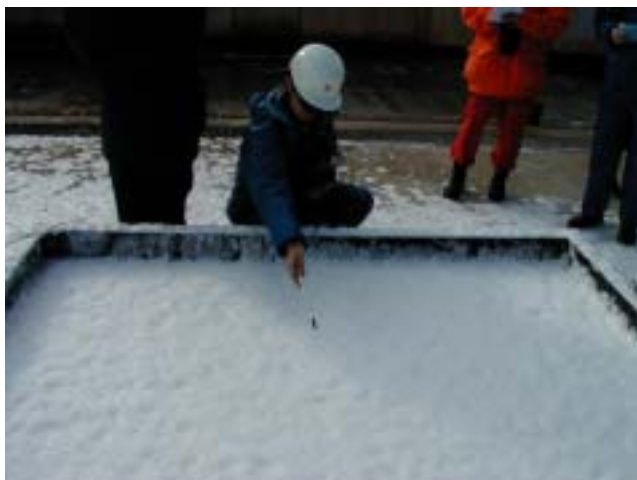
092 散布後ペーパー濃度測定
