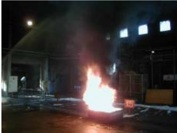
015 キシレン消火（水のみ）（2.3m）
