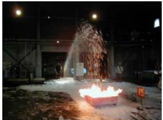
062 アセトン消火 AFFF (1.7m)
