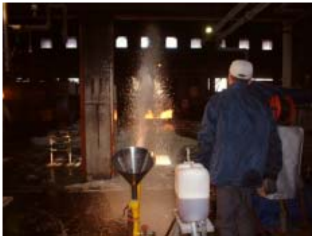
085 アセトン消火ゲル泡 (1.6 m)
