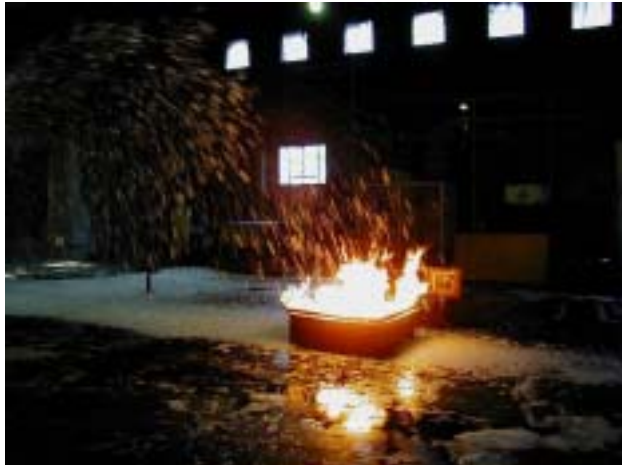
077 アセトン消火ゲル泡 (1.6 m)
