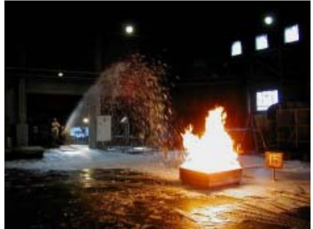
058 アセトン消火 AFFF (1.7m)
