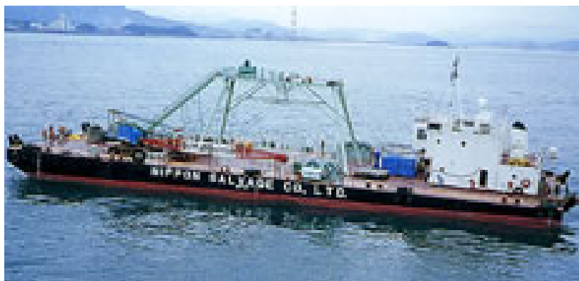
写真IV-16 多目的作業用台船の例
