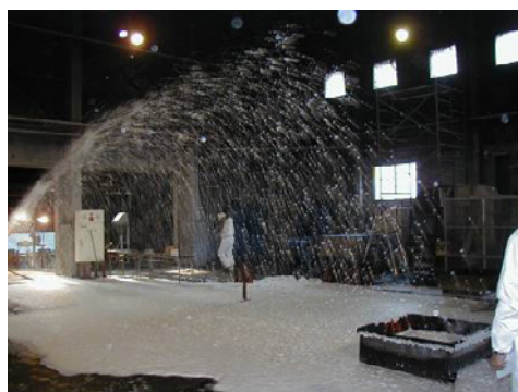
ゲル泡によるアセトンの消火状況
