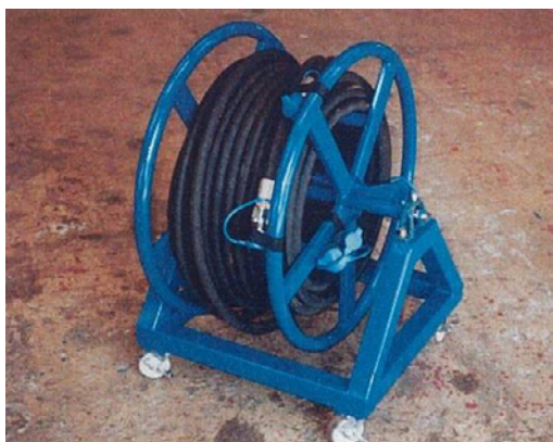
写真IV-10 油圧ホースの格納状況
