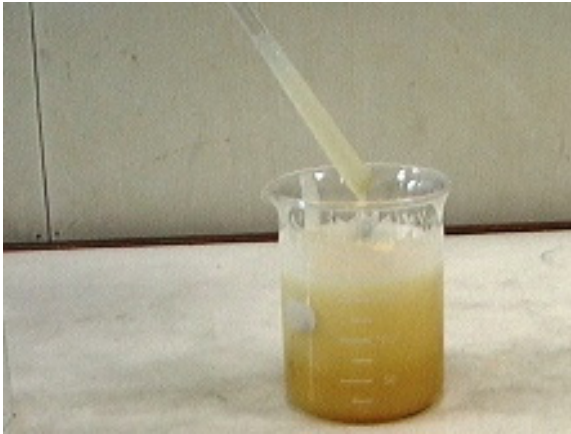
写真Ⅲ-5 ポリマー投入後攪拌した状態
