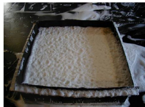
泡厚 10 cmで被覆 ガスを完全に抑制
