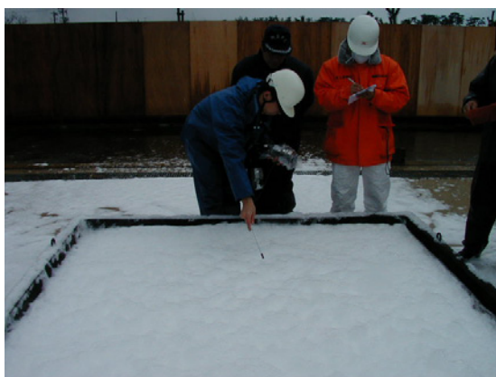
写真Ⅲ－36 ゲル泡散布後ガス濃度計測
