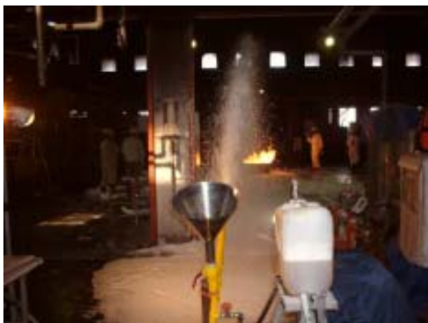
067 アセトン消火 AFFF (1.7m)
