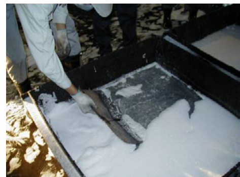
ゲル化剤による固化状況
