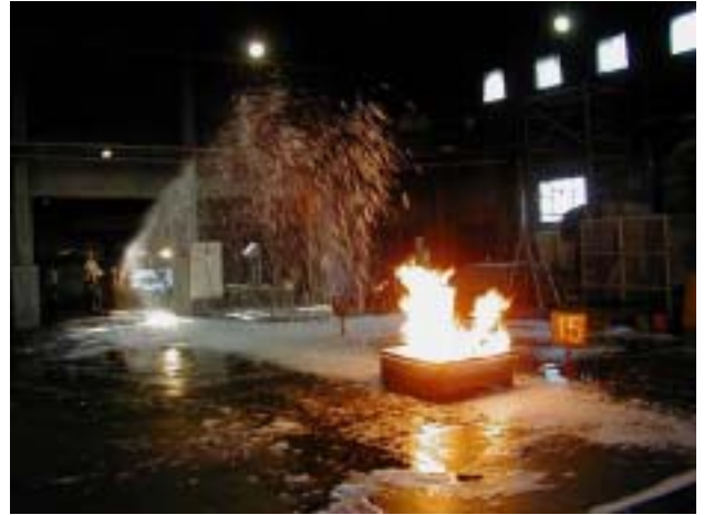
076 アセトン消火ゲル泡 (1.6 m)
