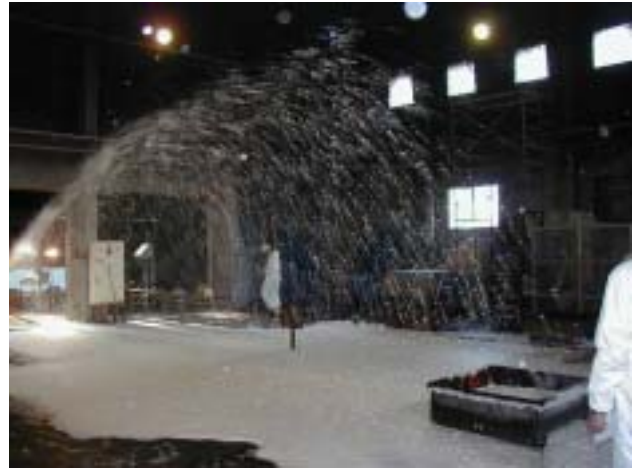
090 アセトン消火ゲル泡 (16m)
