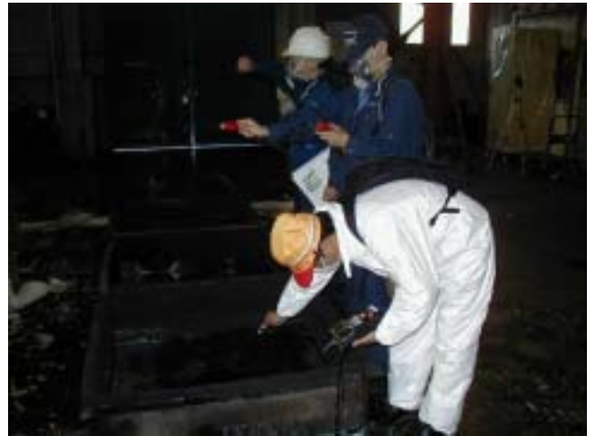
047 ベーパー濃度測定 (実験開始前)
