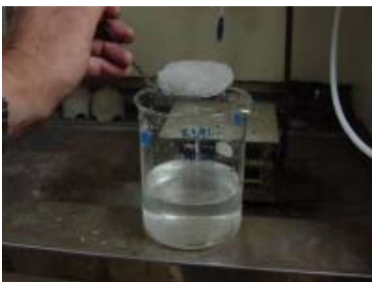
28. メシチレン (吸収性ポリマー；60分後、水洗後) 写真Ⅱ-14 ガス抑制試験、固形化試験 (ゲル泡及び吸収性ポリマー)
