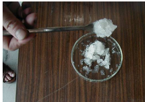
キシレン 20cc 吸収性ポリマー5cc (25%) 固形化状況
