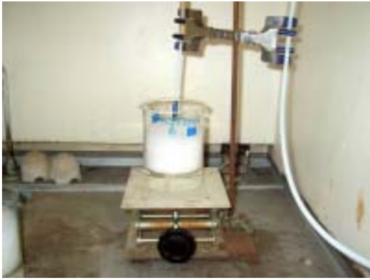
38. ブチレングリコール (吸収性ポリマー ; 60分後) (水にすぐ溶ける)
