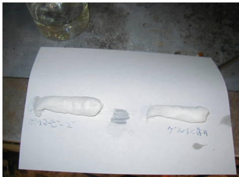
2. 吸収性ポリマー (左)、粉末ゲル化剤 (右) をガーゼに包む
