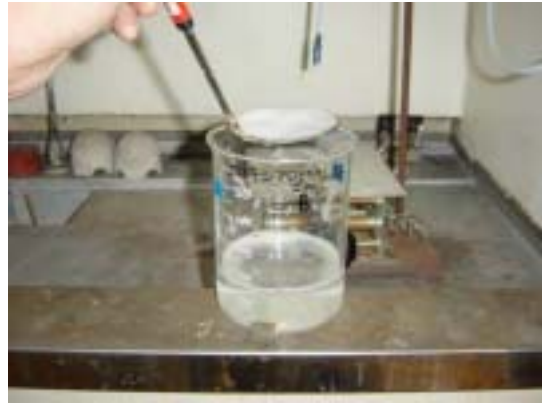
112. 3-エトキシプロピオン酸エチル (吸収性ポリマー；60分後)
