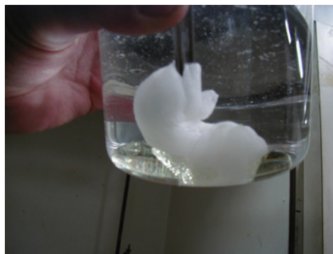
2. 吸収性ポリマー (左)、粉末ゲル化剤 (右) をガーゼに包む
