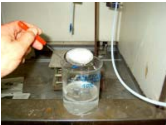
160. エチレングリコールモノエチルエーテルアセテート (吸収性ポリマー；60分後，水洗後) 写真Ⅱ-35 ガス抑制試験、固形化試験（ゲル泡及び吸収性ポリマー）
