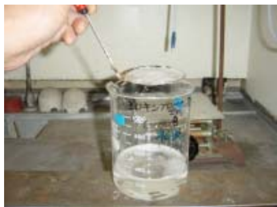
112. 3-エトキシプロピオン酸エチル (吸収性ポリマー；60分後、水洗後)
