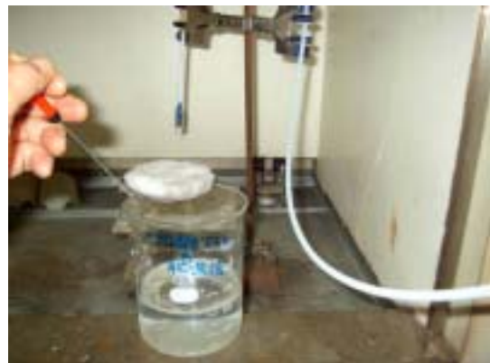
70. 酢酸ブチル (吸収性ポリマー ; 60分後, 水洗後)
