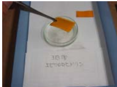
36. エピクロロヒドリン (72 時間浸漬後)
