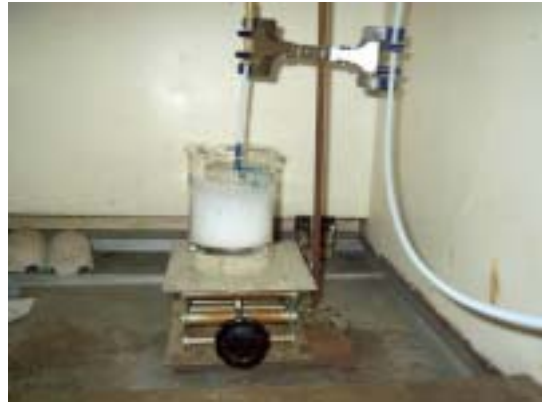
126. ピリジン (吸収性ポリマー；60分後) (水にすぐ溶ける)
