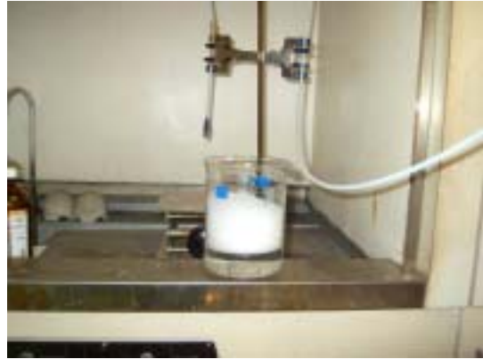
13. アセトン (吸収性ポリマー；60分後) (軽くかき混ぜるとすぐ水に溶ける)
