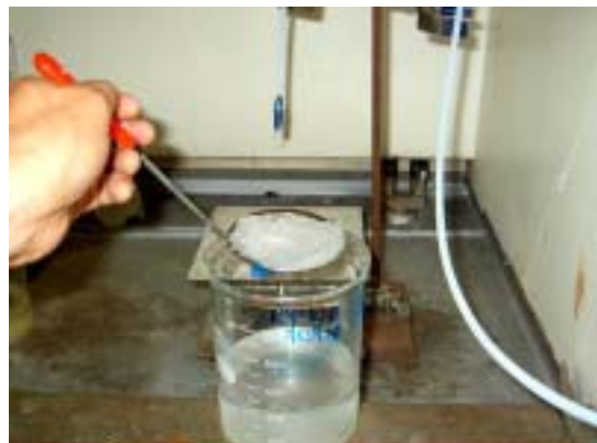
60. ドデセン (吸収性ポリマー ; 60分後, 水洗後)
