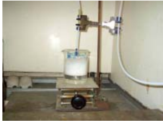
37. ジエチレングリコール (吸収性ポリマー；60分後) (水にすぐ溶ける)
