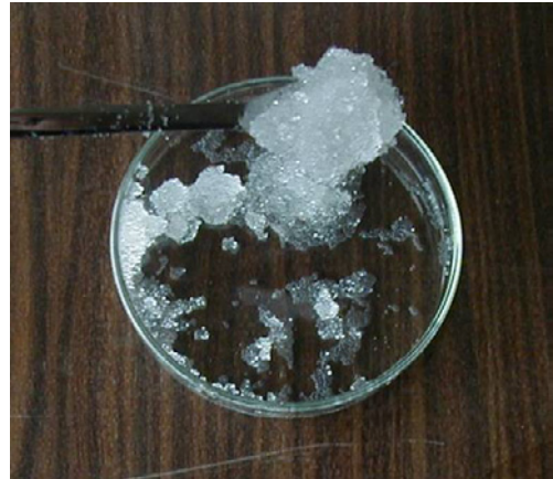
トルエン 20cc 吸収性ポリマー4cc (20%) 固形化状況
