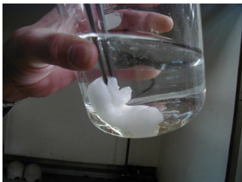
3. 吸収性ポリマーのニトロベンゼン吸着状況 (ガーゼに包んだ吸収性ポリマーに吸収されず)
