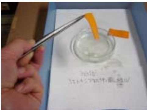
112. 3-エトキシプロピオン酸エチル (72 時間浸漬後) (写真中の物質名は誤り)
