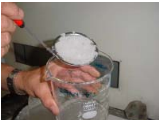
50. エチルベンゼン (吸収性ポリマー；60分後，水洗後)
