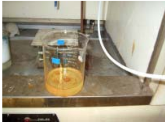
33. アニリン (水にかなり溶けるが少し浮き、 少し沈む)
