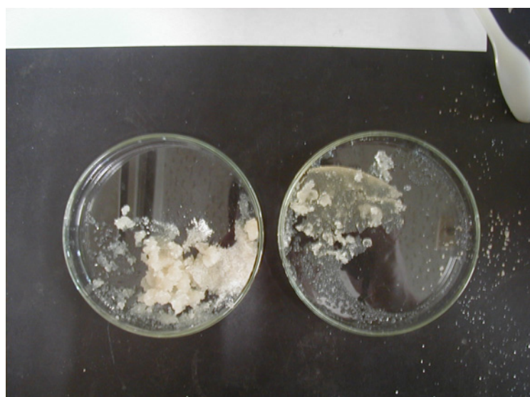
固形化した粉末ゲル化剤（左）：固形化した吸収性ポリマー（右）
