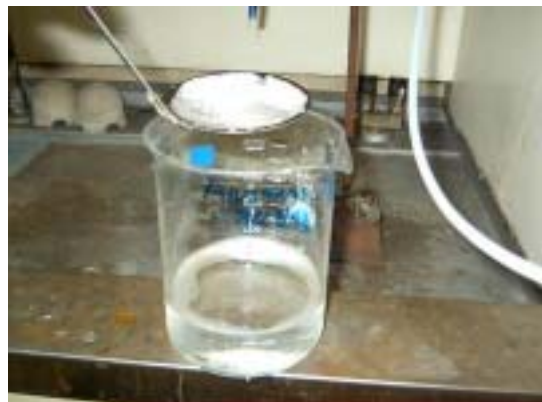
16. メチルエチルケトン (吸収性ポリマー；60分後，水洗後)
