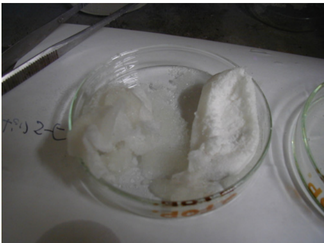
5. ガーゼに包んでいた吸収性ポリマー（ビーカー内の左）、 粉末ゲル化剤（ビーカー内の右）の状況 (両者とも吸収または固形化せず)
