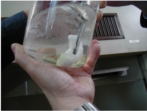
4. 粉末ゲル化剤のニトロベンゼン吸着状況 (ガーゼに包んだ粉末ゲル化剤に吸収されず)
