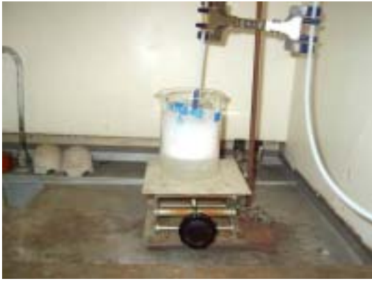
94. メタクリル酸 (吸収性ポリマー ; 60分後) (水に白濁して溶ける)
