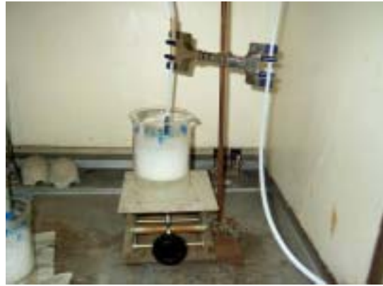
158. モルホリン (吸収性ポリマー；60分後、 すくえるほど固化物がない) (水に白濁して溶ける)
