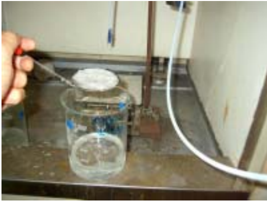
142. イソホロン (吸収性ポリマー; 60分後, 水洗後)
