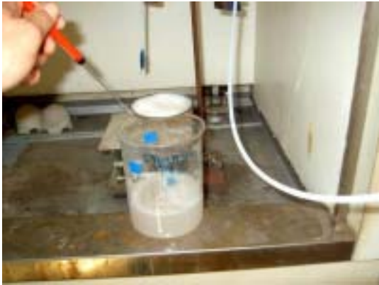
111. シクロヘキシルアミン (吸収性ポリマー；60分後、 水洗するほど固化物がない)
