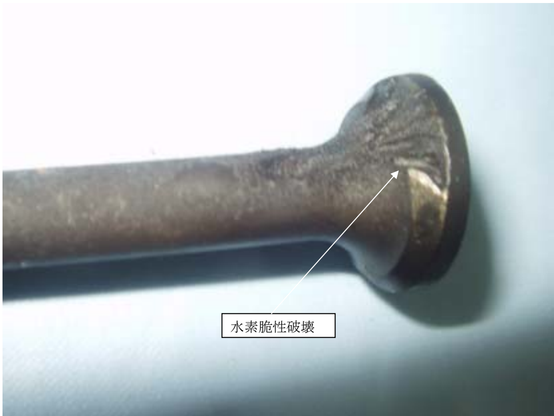
図 3-5. 分解後の副室制御弁
