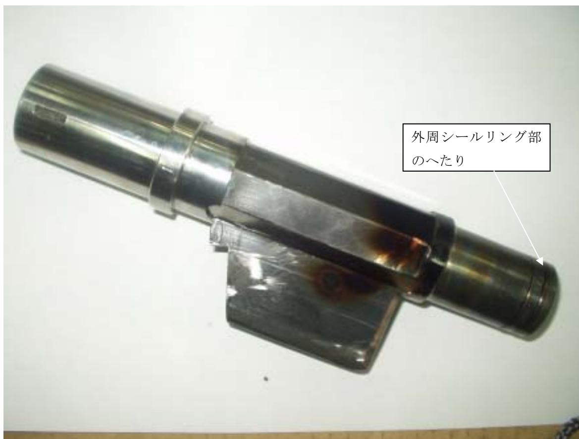
図 3-1. 分解後の副燃焼室
