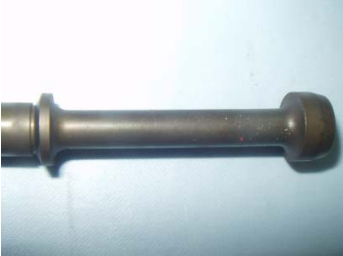
図 2-25. 使用後の副室バルブの絞り部
