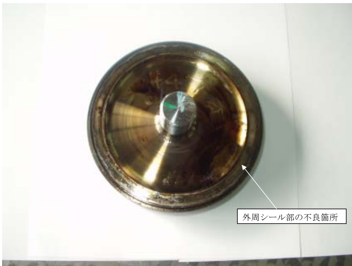
図 3-3. 分解後の PISTON CROWN のシール部
