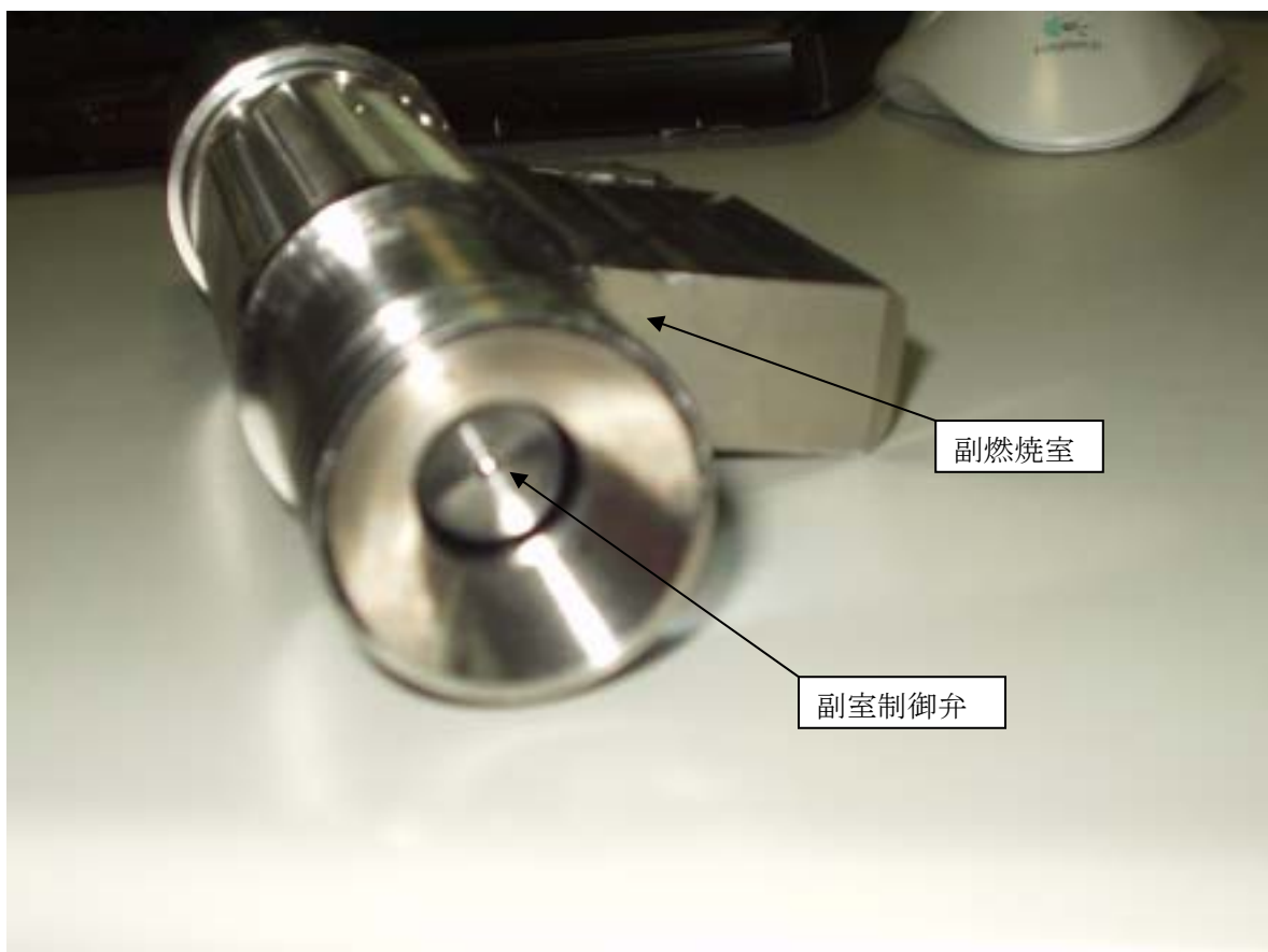
図 3-21. 副燃焼室組立状況
