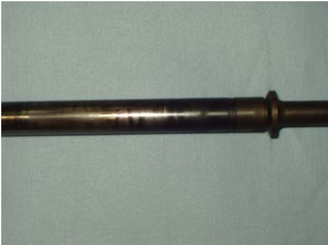
図 2-25. 使用後の副室バルブの摺動部
