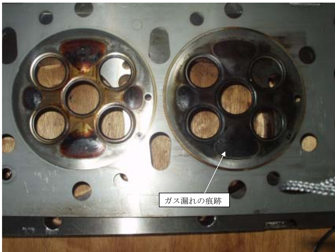
図 3-2. 分解後のガスケット写真
