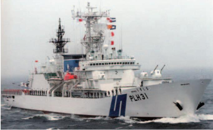
巡視船「しきしま」(7,175総トン)。船橋前に35mm連装機関砲および20mm多銃身機関砲2基が見える。「しきしま」は、わが国巡視船としては重武装で対空レーダーも装備し、武力紛争時に補助兵力として使用するための相応の能力がある。(写真:読売新聞社)
