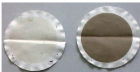
写真2: 古座川本流の水と小川の水を濾過したものの比較。左が小川、右が古座川のもの。
