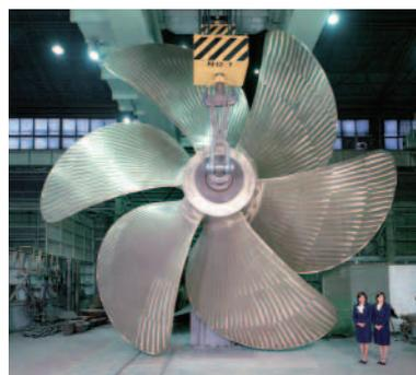
6翼、直径9mの大型プロペラ
