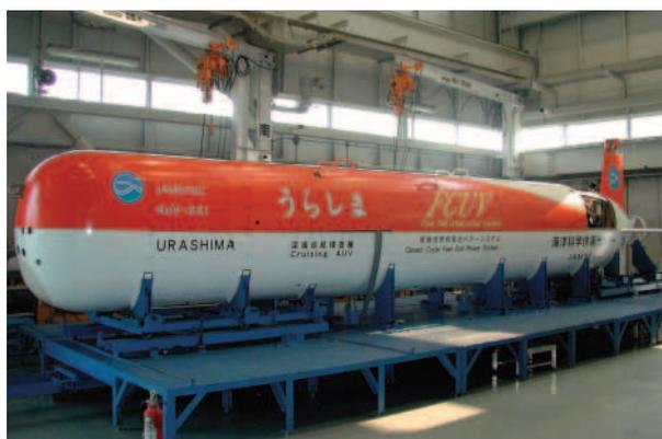
開発中の自立型無人潜水艇。海の状態等を継続的にモニターする。動力源、識別能力(通信・航法・観測)、作業性能等の開発は革新的技術の粋である。開発中の海中自立ロボットは自立式鯨追尾用などの他にも多数ある。「何時でも・何処でも・何にでも」が合言葉。
