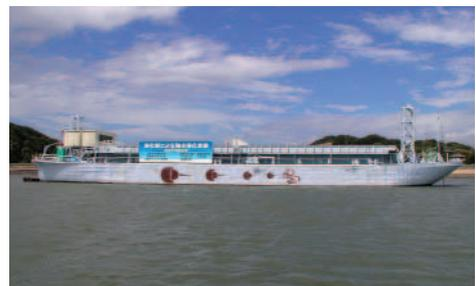
海水の浄化を目的に土運船を改良して造られた浄化実験船。船体にはきれいな海を取り戻したいという願いが込められ、カブトガニが描かれている。
