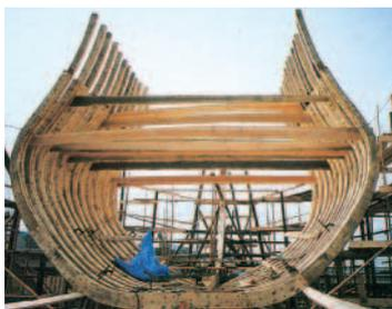
サン・ファン・パウティスタ復元船は、船大工の高齢化という困難を克服して平成5年10月に完成した。(写真は平成4年3月26日の中央部肋骨立揃)
