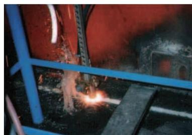
左/メガフロート技術研究組合と作成した水中補修溶接装置
