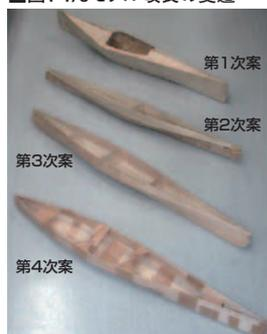
船造りでは、初めに各自がイメージする競漕艇の10分の1のモデルを紙細工で製作し、クラス内でプレゼンテーションをする。この中から、ブレインストーミングを通してクラス艇のベースとなるモデルを2~3案程度選び出す。20ほどの紙模型から如何にして絞り込むかに、各クラスの勝利に向けた様々な思いや戦略が反映される。採択されたベース・モデルの数に応じてクラス内を小グループに分け、各モデルの担当とする。各グループは、5分の1模型を化粧ベニヤ(板厚2mm)で製作するとともに水路試験を実施し、実艇とした場合の諸性能を検討しつつ改良を加え、ベース案の熟成に努める(図1)。
