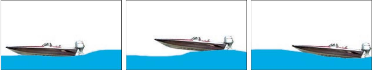
**良い例**：波に突っこむ前に速度や進入角度を調整し姿勢が激しく変化しないようにボートを押さえ込みます
