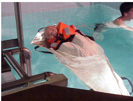
「移動用補助・降下袋」の浮遊状態 (SOLAS 型救命胴衣着用)
