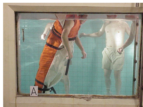
改良型「移動用補助・降下袋」の浮遊状態 (小型船舶用救命胴衣着用)
