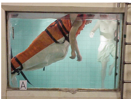
改良型「移動用補助・降下袋」の浮遊状態 (小型船舶用救命胴衣着用)
