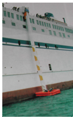
シューター及びプラットフォーム
