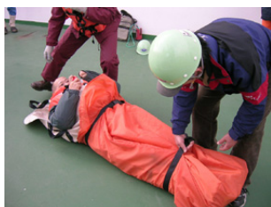
2004/10/25-26 試験で使用した「移動用補助・降下袋」にナイロンカバーをつけた状態
