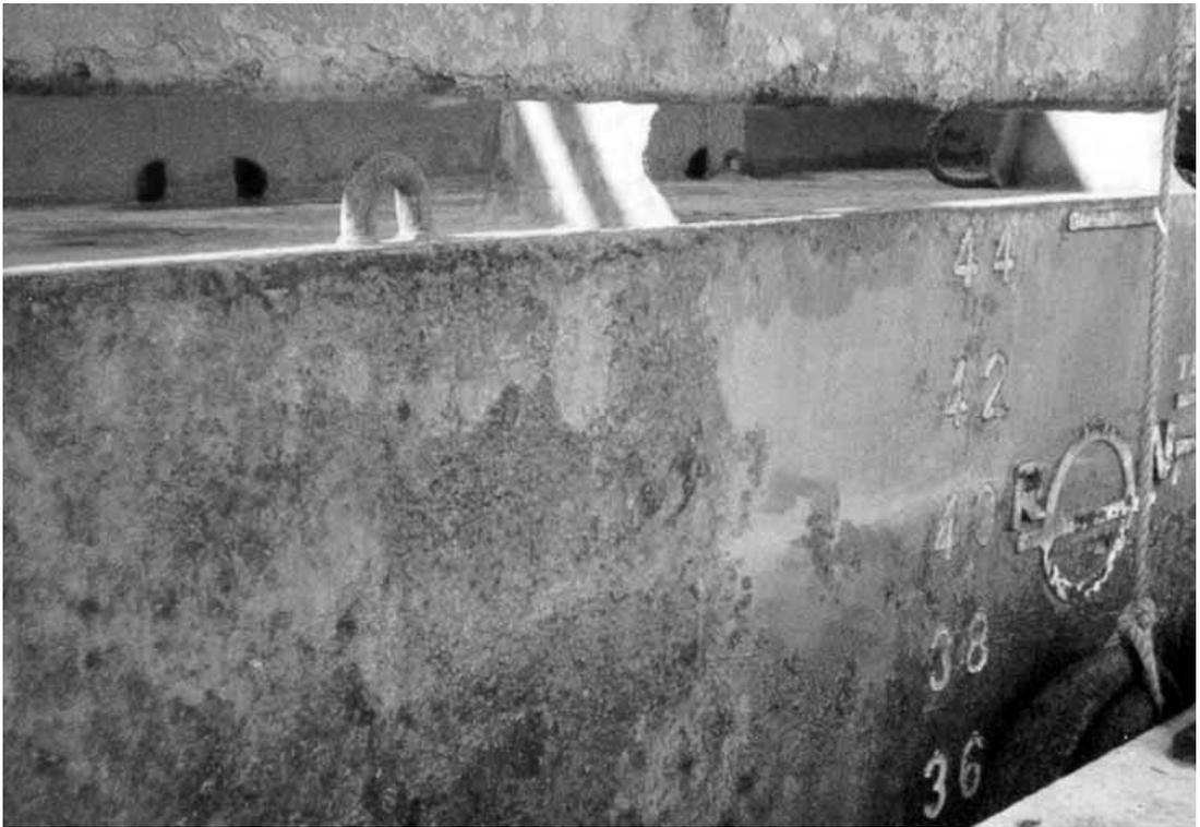
整備不良から手入れもされず、船側の外板は錆が浮き腐食が進む（写真：パリ MOU ウェブサイトから）
