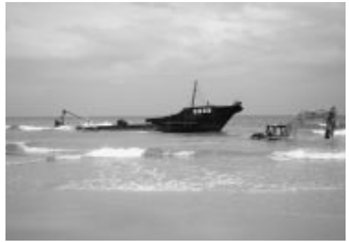
放置されて約4カ月後。船橋は崩れ、波が船体を洗っている横には砂の穴に埋もれたショベルカー
