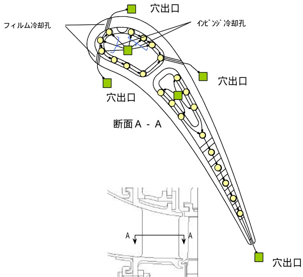
第1段タービン静翼のフローネットワークモデル
