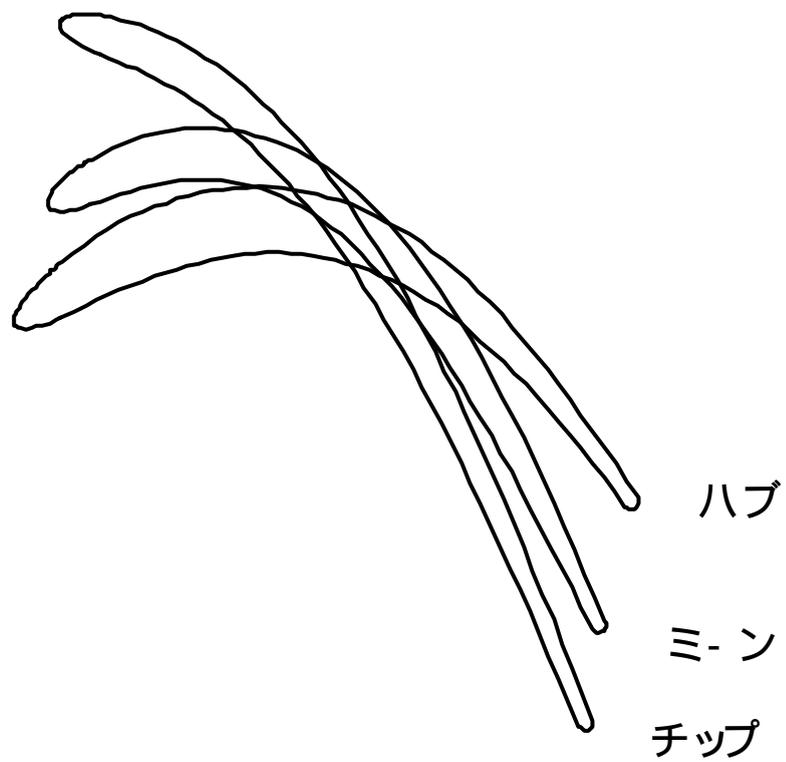
図2.2.2-13 V型パワ-タ-ビン 2段動翼翼形状
