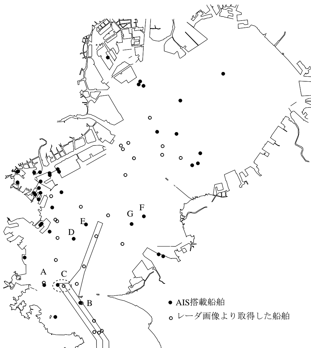
Fig.1.1-9 レーダ画像から取得した船舶位置と AIS による位置のプロット図
