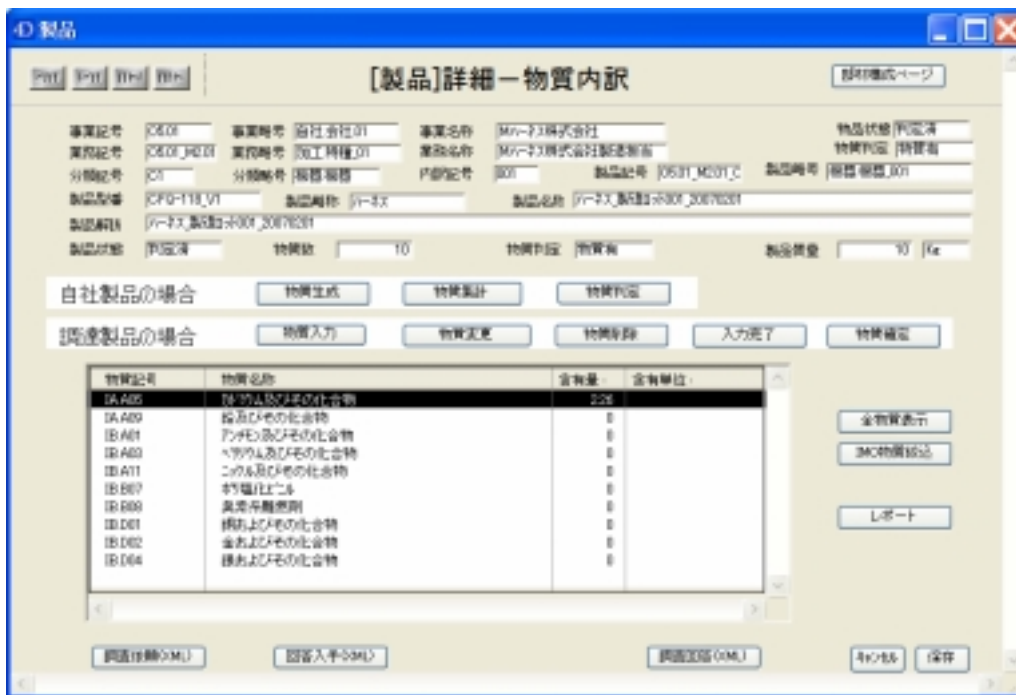
図 8-39 個別に物質含有量を集計した結果の『含有物質情報』ページ
