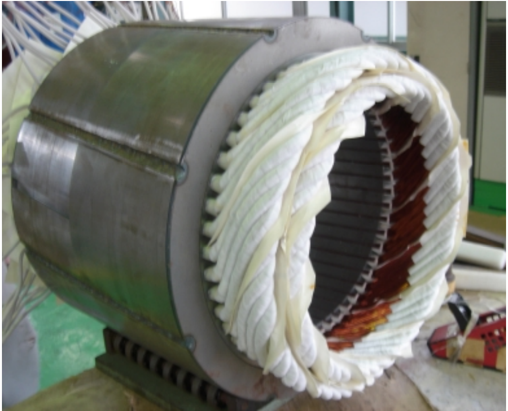
図 2.2-2 90kW 4P のステータ
