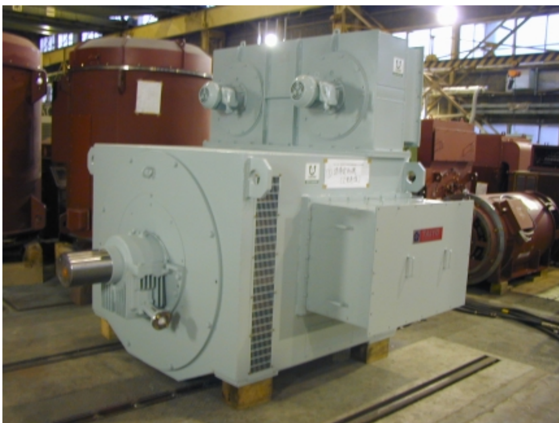
図 2.6-3 2000kW 誘導電動機組み立て完了
