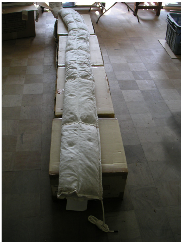
写真-IV. 3. 2 試作中の河川用小型杉樹皮製油吸着材（新開発品）
