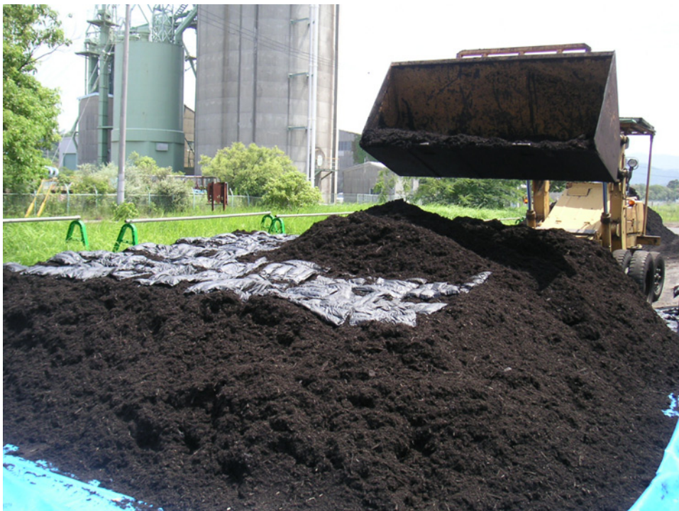
写真－Ⅱ． 3． 3 パイル断面に並べた吸着マットを被覆する様子
