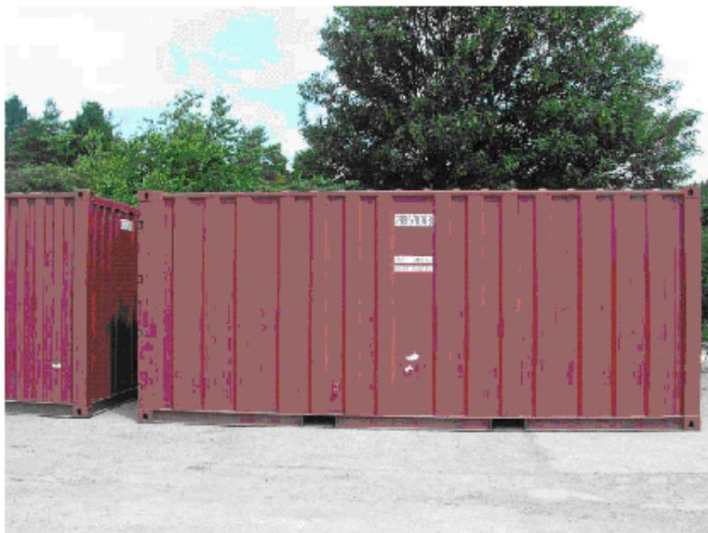
図 3.15 ISO コンテナ (IP-II) の概観
