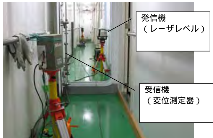
図 3.2.6 たわみ計測の例
