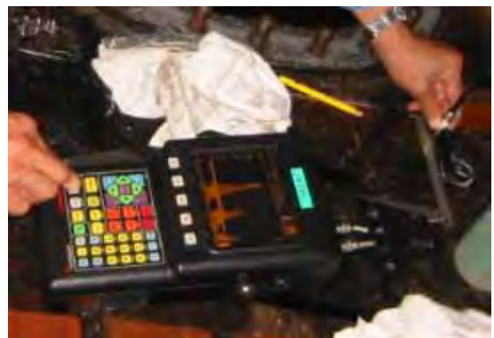
図 3.2.2 B1-B2 計測を用いた板厚計測
