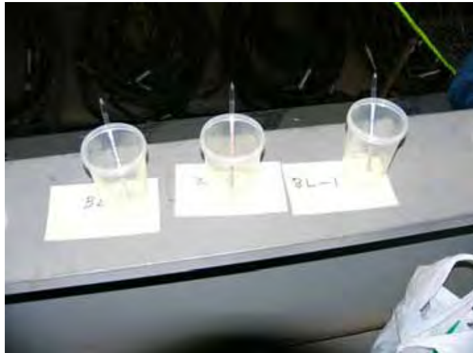
写真 4.1.1-2 イオン検知管による塩素イオン測定 (ISO8502-5)
