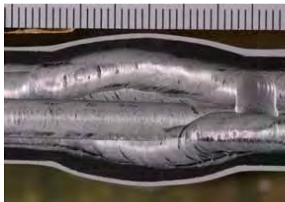
突き合わせ溶接部
