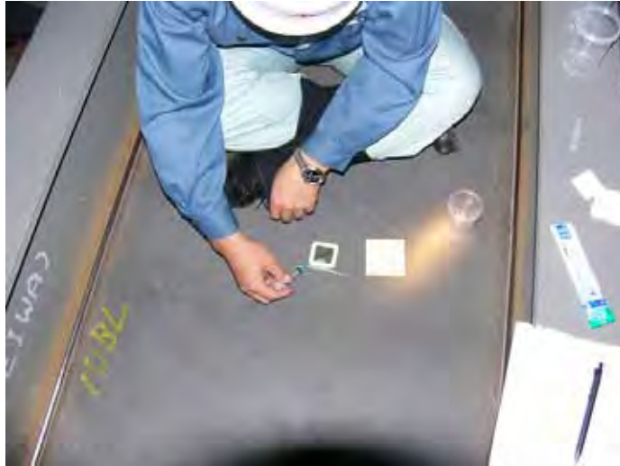
写真 4.1.1-1 プレセルパッチ法(ISO8502-6)による計測
