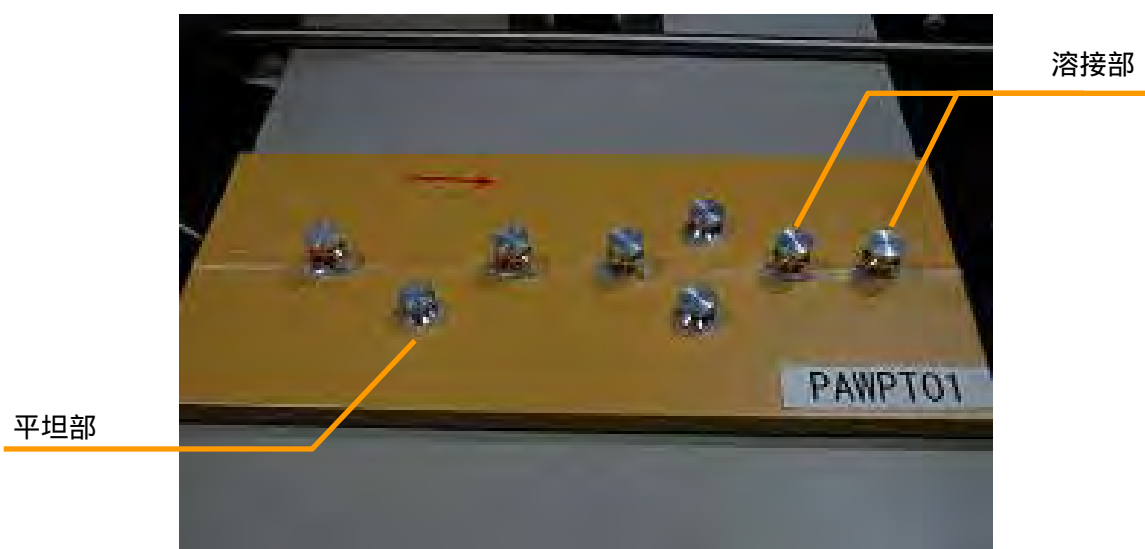
Photo4.3- 2 ドリー接着状況
