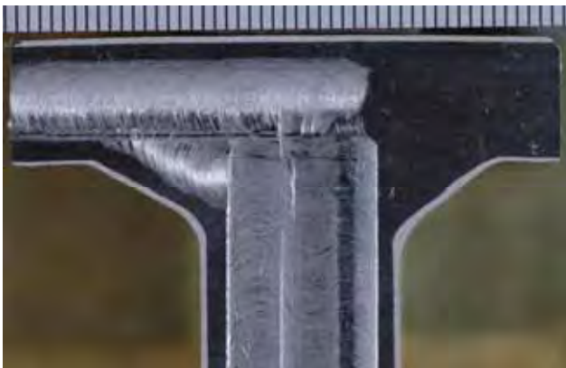
隅肉溶接部 (上部)
