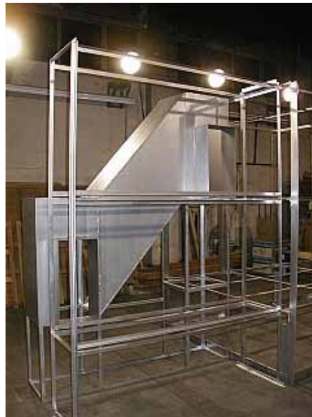
写真 3.2.2 階段室モデル (製作中: 写真 3.2.1 の廊下の背後に接続する)
