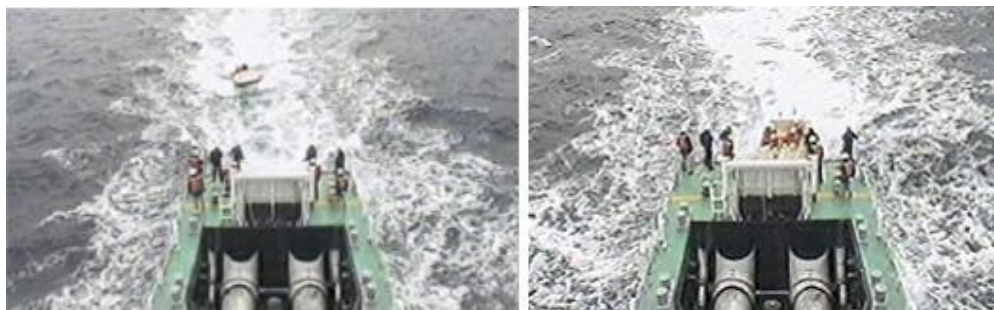
図 4.4.2.8 船速 10kts で追走中の警救艇 (右は船尾波により閉じ込められた状態)
