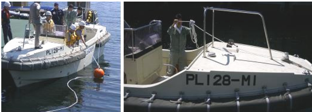
図 4.4.1.5 テレスコピック（左）の使用形態とペンダントロープ（右）の概要
