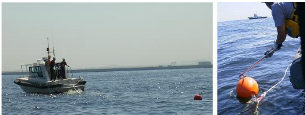
図 4.4.1.6 停船時揚収試験の様子
