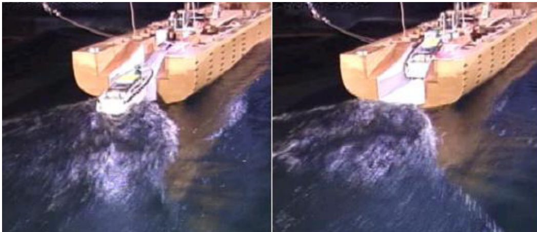
図 4.3.2.5 規則波中船尾降下揚収試験の様子（船速 15kts 波高 2m 波長船長比 0.7）
