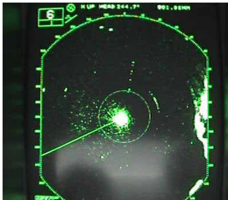
図 5.1.46 レーダ画像上の S A R T 信号の例
