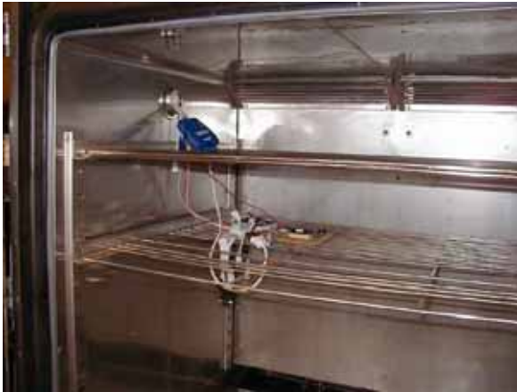
図 5.2.14 恒温恒湿槽内の状況
