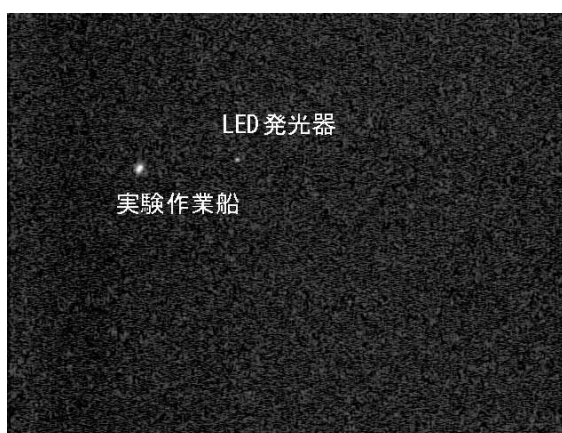
図 5.1.64 ガンマ補正による強調処理結果
