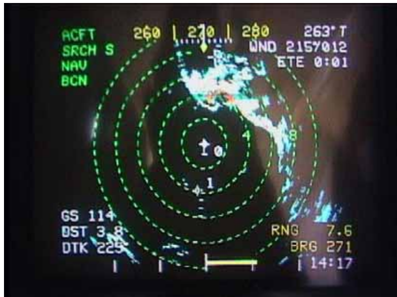
図 5.1.50 航空機によるレーダ画像の例
