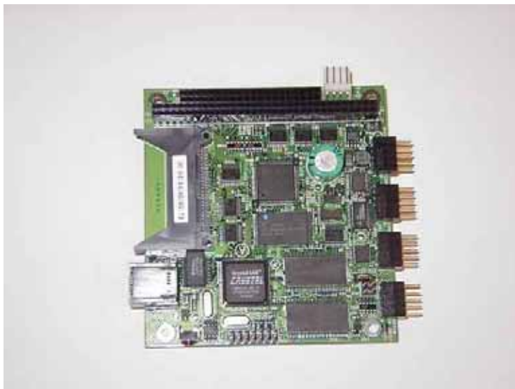
図 5.2.5 CPU ボード A 社製
