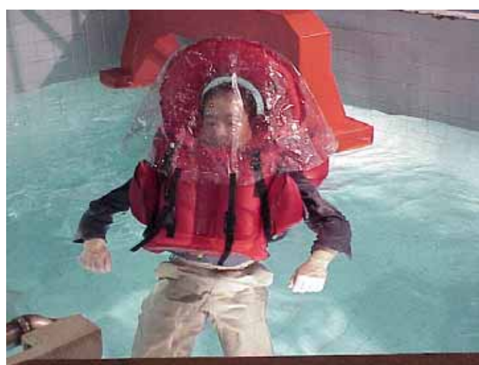
図 4-2-8 救命胴衣モックアップ（大人用）浮遊試験
