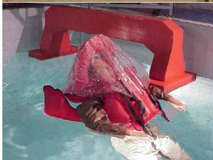
図 4-2-9 救命胴衣モックアップ（大人用）浮遊試験
