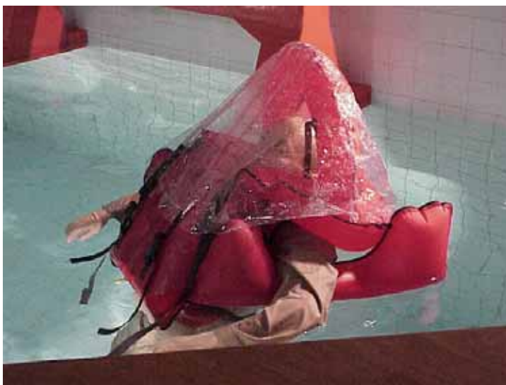
図 4-2-10 救命胴衣モックアップ（大人用）浮遊試験
