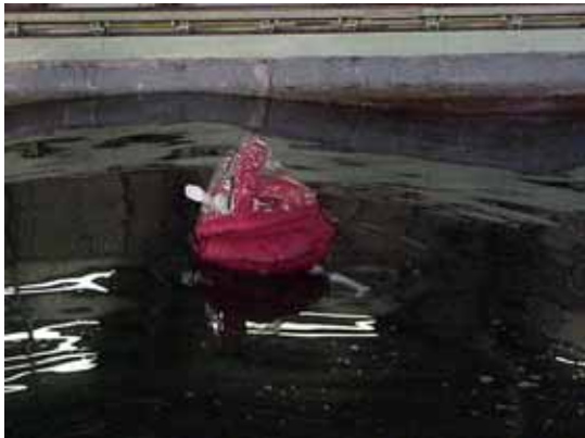
図 4-2-12 救命胴衣モックアップ（幼児用）波浪中浮遊試験
