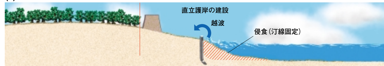
土堤および背後の保安林を侵食から守るために直立護岸が建設された。しかし侵食がなお続き、護岸前面が深くなるため越波が激しくなった。
