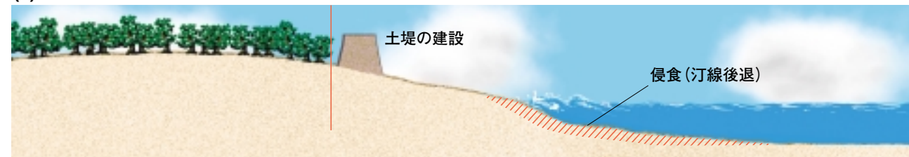
新しく形成された保安林を飛砂や飛塩から防護するために保安林の最も海側に土堤が建設された。ちょうど時を同じくして侵食に伴う汀線の後退が始まった。
