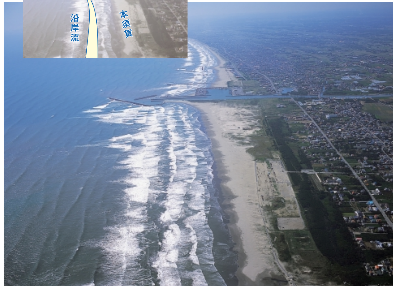
写真下から上へ向かって流れる沿岸流を防波堤が遮っているため、漁港の北側(写真下)の海岸線では砂の堆積が顕著である。(2001年9月24日 撮影)
